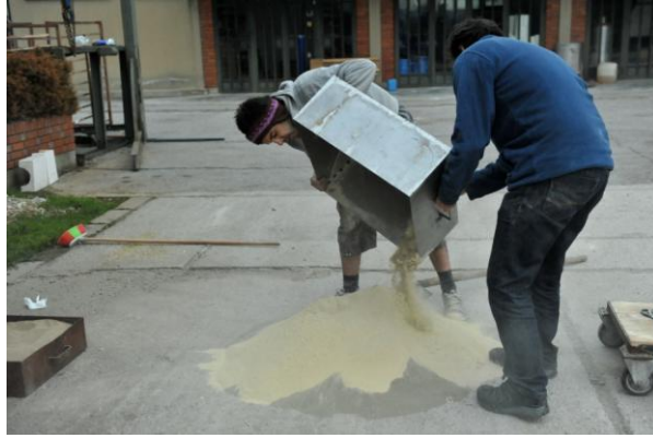
Resim 6.6. Bentonit Bağlayıcısının Kuru Kuma Eklenmesi
