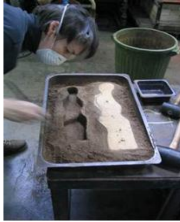
Resim 4.13. Model Boşluğu Üzerinde Düzeltmeler Yapılması
