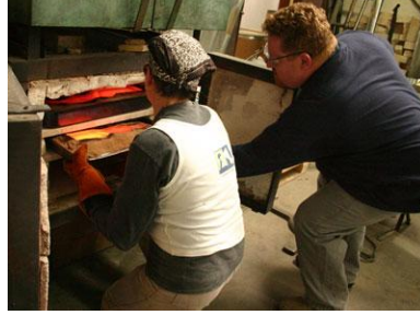
Resim 4.23. Tavlama Fırınına Dökülmüş Ürünün Yerleştirilmesi
