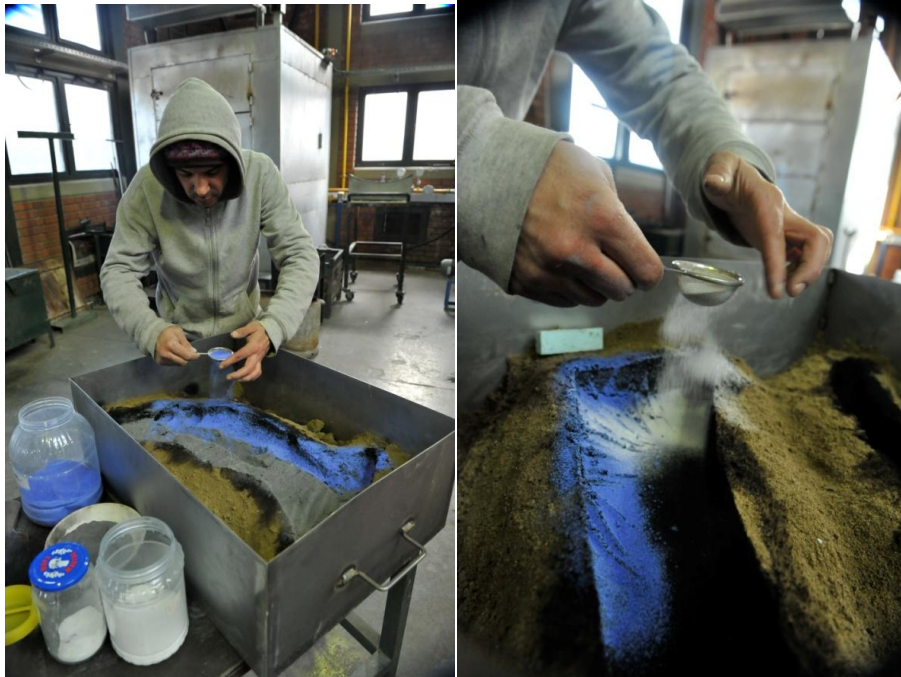
Resim 6.11. Kum Kalıbın Renklendirilmesi
