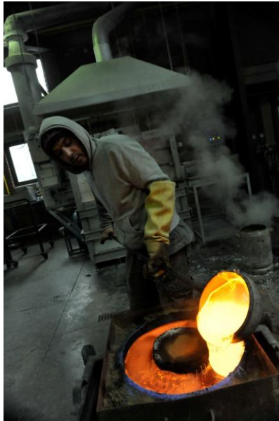
Resim 6.16. İkinci Dökümün Yapılması
