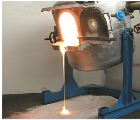
Resim 3.2. Falorni Firmasına Ait Devirmeli Cam Potası
