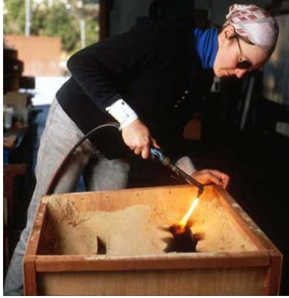
Resim 3.18. Hazırlanmış Kum Kalıp İçerisine Karbonizasyon İşlemi Yapılması
