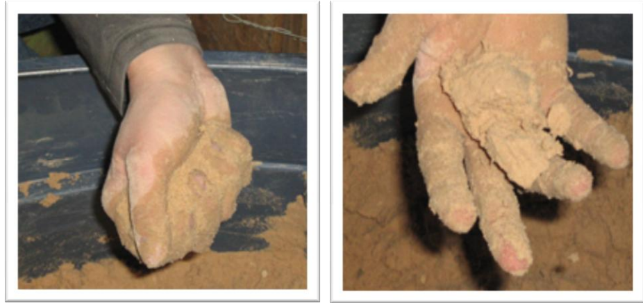
Resim 4.4. Islatılmış Kumun Yapışkanlığının Kontrol Edilmesi
