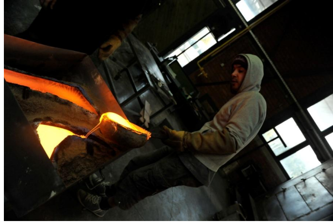
Resim 6.15. Kum Kalıba Birinci Dökümün Yapılması
