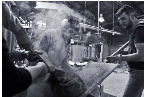
Resim 6.21. Kum Kalıptan Çıkartılan Camın Tavlama Fırınına Taşınması
