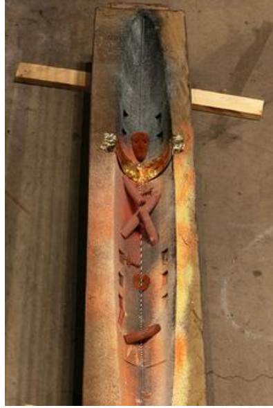
Resim 4.17. Kum Kalıp İçerisine Yerleştirilmiş Bakır Parçaları
