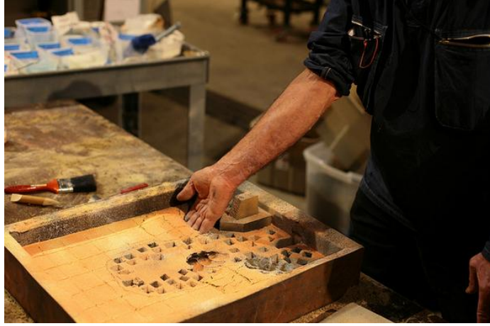
Resim 4.15. Kum Üzerine Negatif Baskı Yapılması
