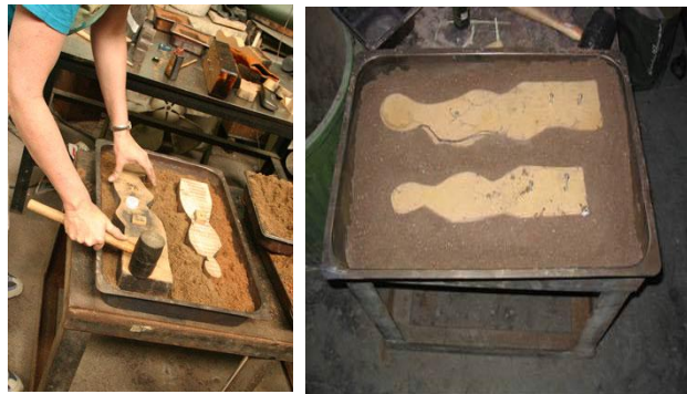
Resim 4.12. Kum Yüzeyine Çekiç Yardımıyla Modelin Bastırılması
