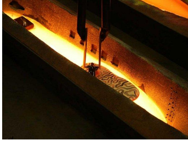
Resim 4.18. Dökülen Cam Katmanları Arasına Farklı Materyal Koyulması
