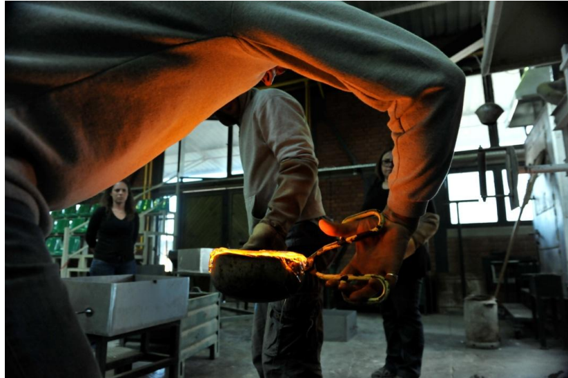
Resim 6.14. Cam Kepçesi Etrafındaki Kirli Camın Makas Yardımıyla Temizlenmesi
