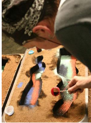
Resim 3.21. Pudra Renklendiriciler İle Kum Kalıp Renklendirme Aşaması
