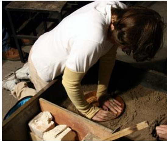
Resim 4.8. Ahşap Modelin Kum Yüzeyine Bastırılması
