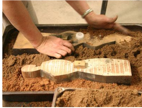
Resim 4.11. Kum İçerisine Ahşap Modelin Yeleştirilmesi
