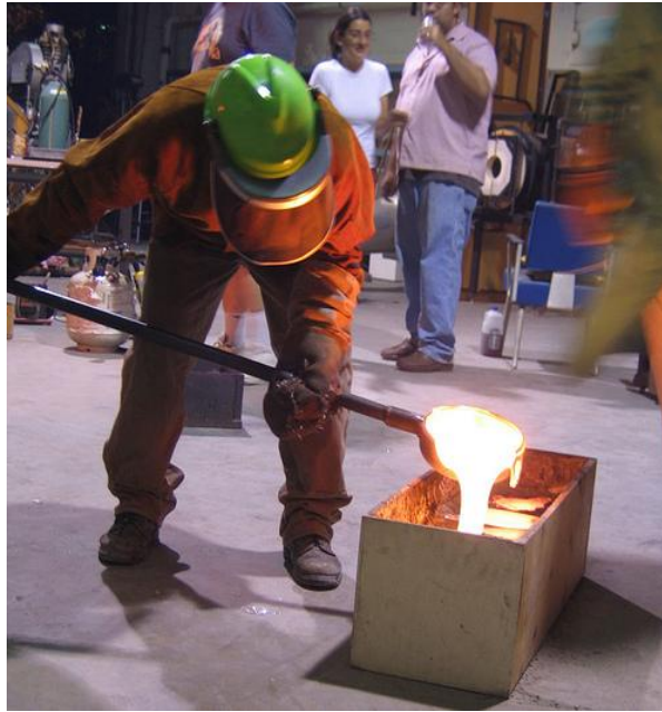
Resim 3.14. Korumalı Kıyafetlerin Döküm Esnasında Kullanımı
