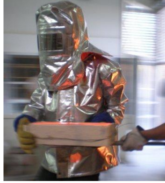
Resim 3.13. Taşıma Küreği İle Camın Taşınması
