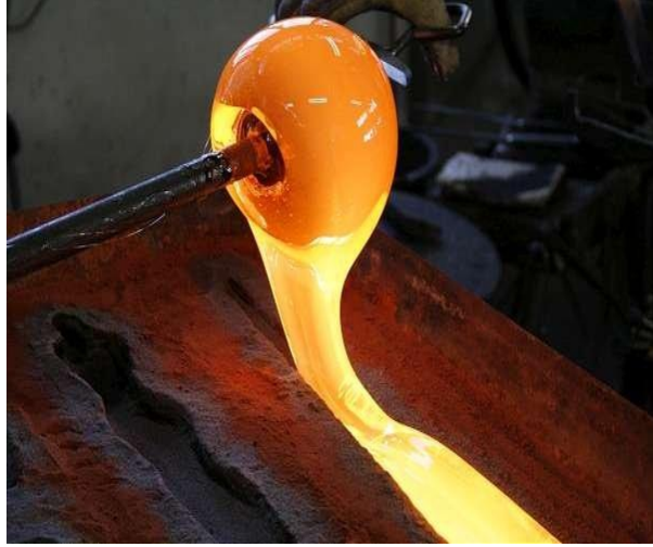
Resim 3.7. Fonga İle Kum Kalıp İçerisine Cam Döküm Uygulaması
