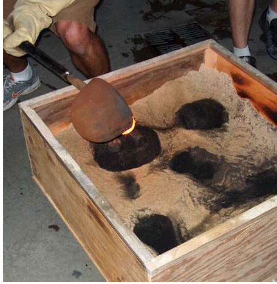
Resim 3.4. Kum Teknesine Cam Dökülmesi
