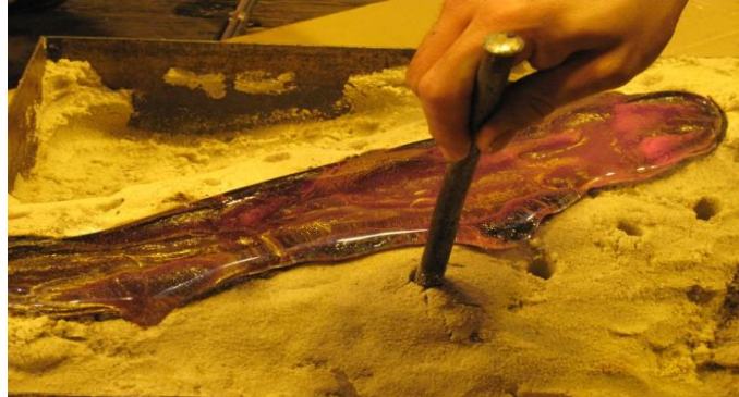
Resim 6.20. Kalıp Duvarlarına Hava Delikleri Yapılması
