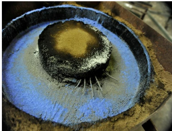
Resim 6.13. Bakır Tel Yerleştirilmiş Kalıp Örneği
