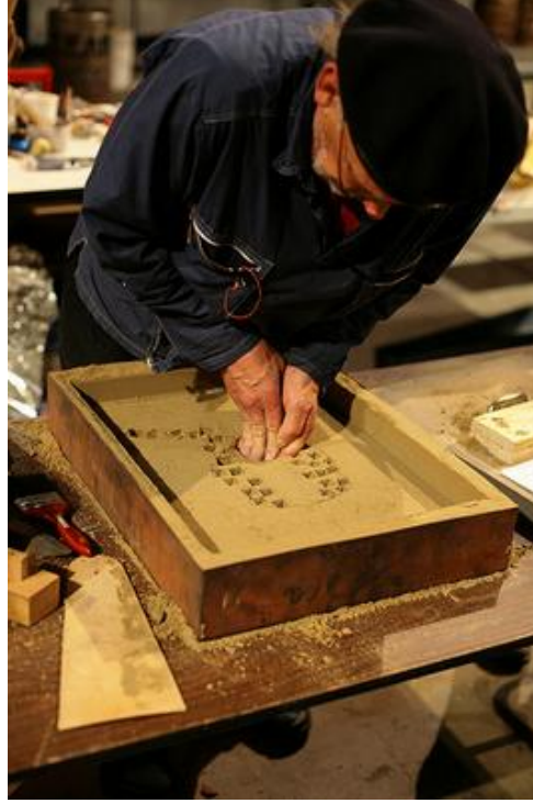
Resim 4.14. Ana Model Boşluğu Üzerine Farklı Desen Etkileri Verilmesi
