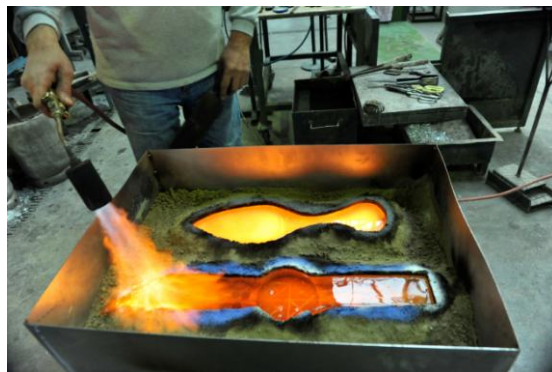
Resim 6.19. Şaloma İle Cam Isısının Dengelenmesi
