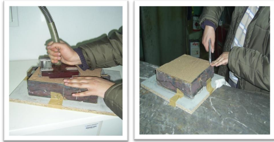
Resim 4.7. Kum Kalıba CO 2 Gazı enjekte Edilmesi ve Sertleşmiş Kalıba Basınçlı Hava Tutulması
