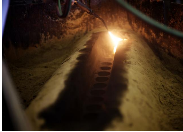
Resim 4.16. Kum Kalıbın Karbonize Edilmesi
