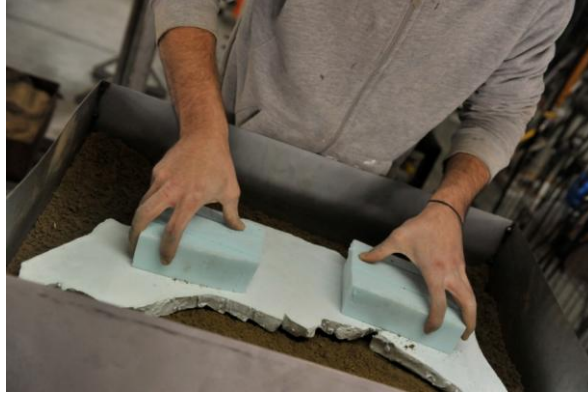
Resim 6.9. Kum Yüzeyine Baskı Uygulanması
