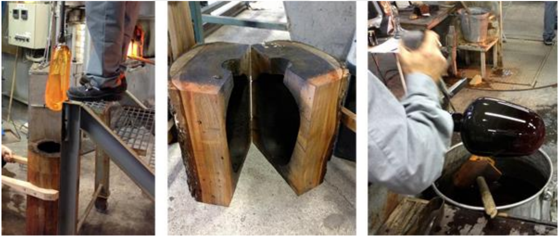
Resim 2.2.1.2.1 Kalıba Üfleme Tekniđi
