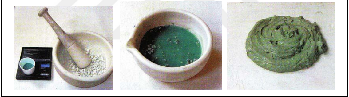
Resim 14 - Kurutulmuş kilin havanda dövülmesi- Bünyenin boya ile karıştırılması
