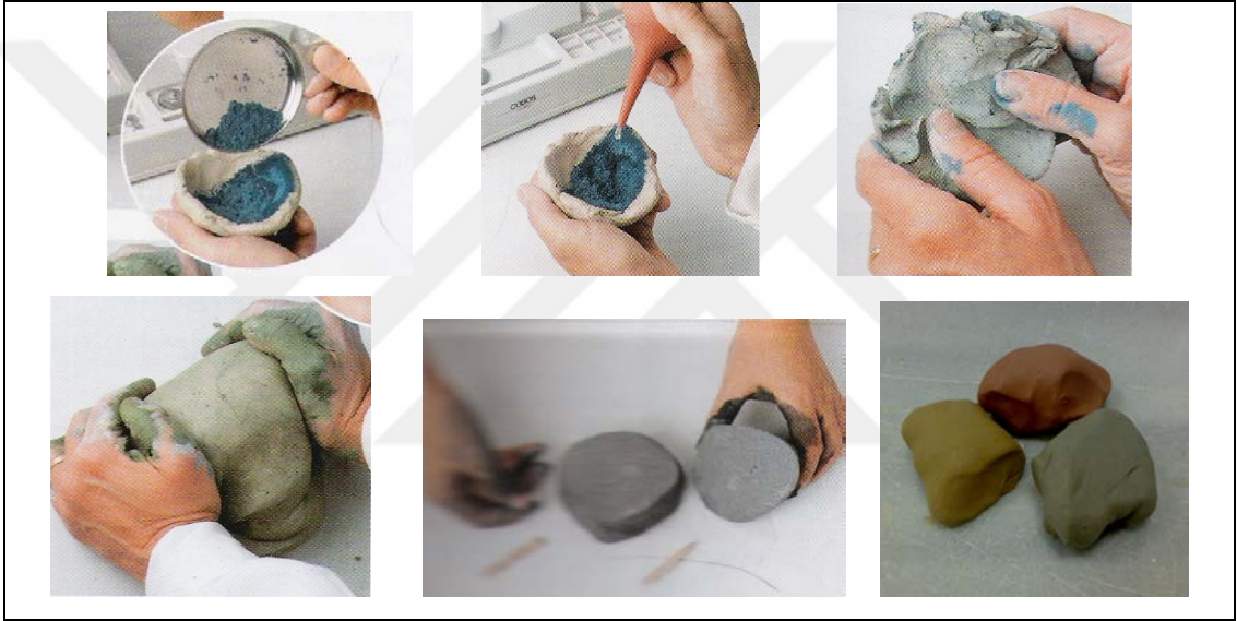
Resim 13 - Renklendirilmiş seramik çamurunun hazırlanması
