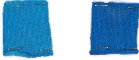
Şekil 4.28: Sırasıyla 100 ppm ve 300 ppm'lik çözeltilerle boyanan üç iplik kumaşın deneme-10 sonrası görünüşleri.
