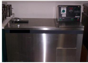
Şekil 3.21: Yıkama haslıđı için kullanılan yıkama makinesi.
