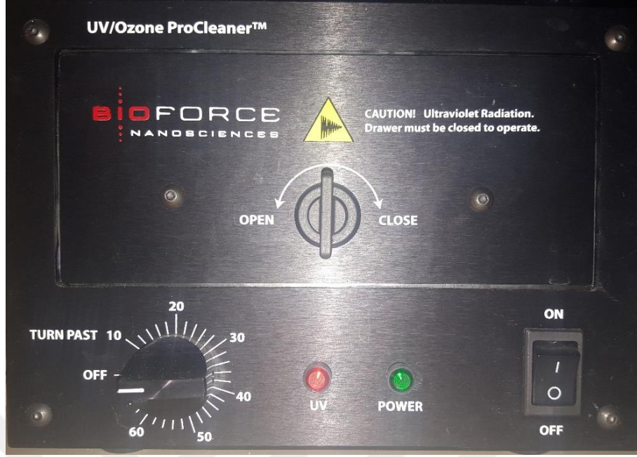
Şekil 3.12: UV ozonla temizleme cihaz görüntüsü.
