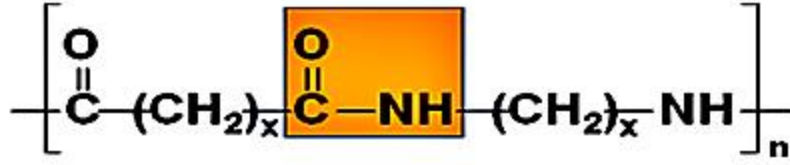
Şekil 3.3: Poliamid kimyasal yapısı.
