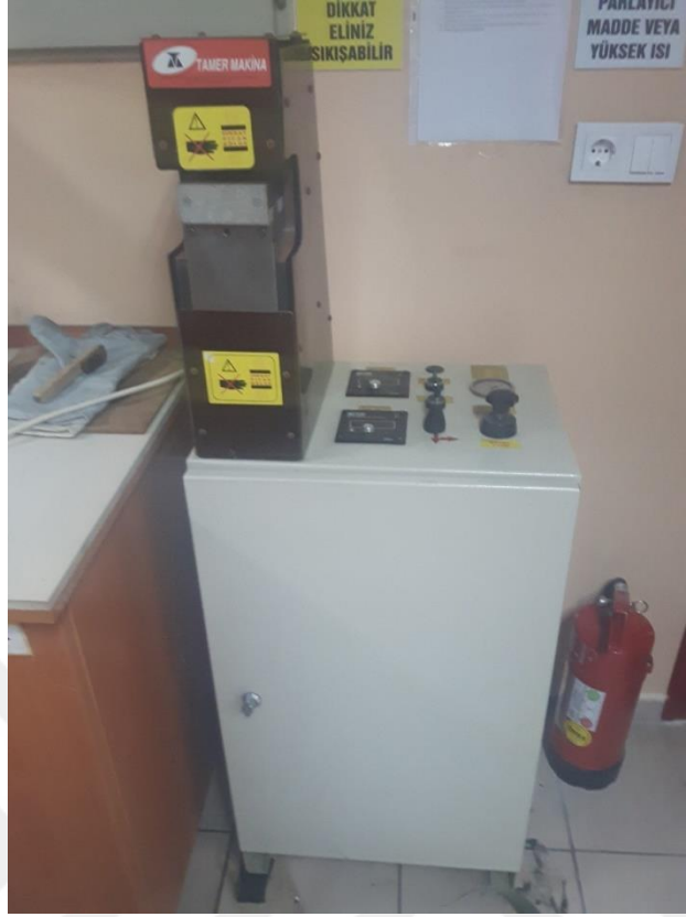
Şekil 3.6: Sıcak pres ünitesi.
