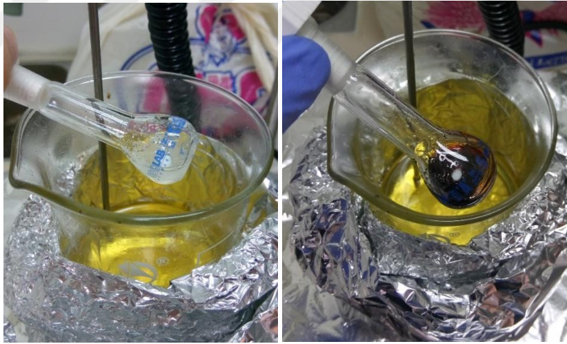
Şekil 4.1: \text{CrCl}_3 \cdot 6\text{H}_2\text{O} katalizörü ile 130^\circ\text{C} 60 dk' da yapılan reaksiyon için (a) Selülozun iyonik sıvı ortamında çözünmesi aşaması (b) Reaksiyon sonrası oluşan ürünler.
