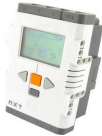
Şekil 2.2. Lego Mindstorms NXT Merkezi Modül
