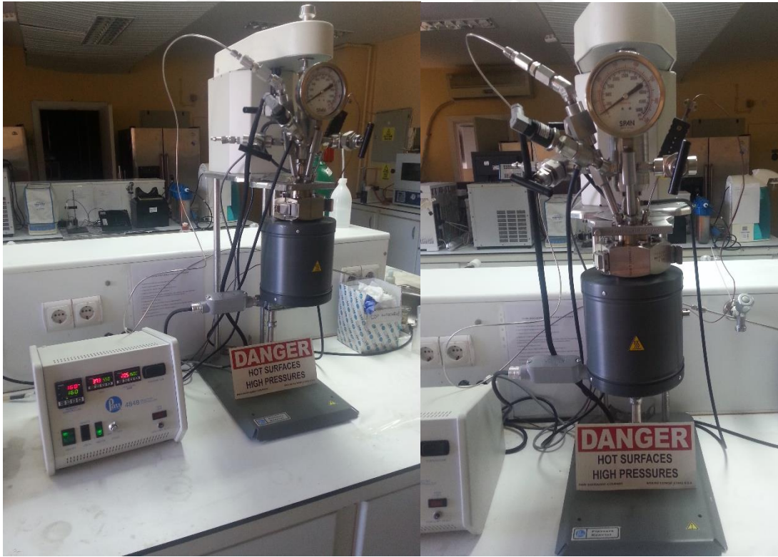
Şekil 3.4: Hidrojenasyon Reaksiyonları için Kullanılan Mikro Reaktör Sistemi.
