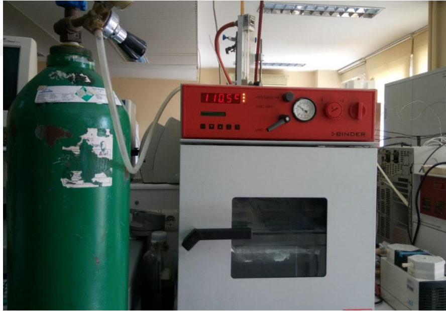
Şekil 3.3: Azot Gaz Akışı Altında Kurutma İşleminin Gerçekleştiği Etüv.
