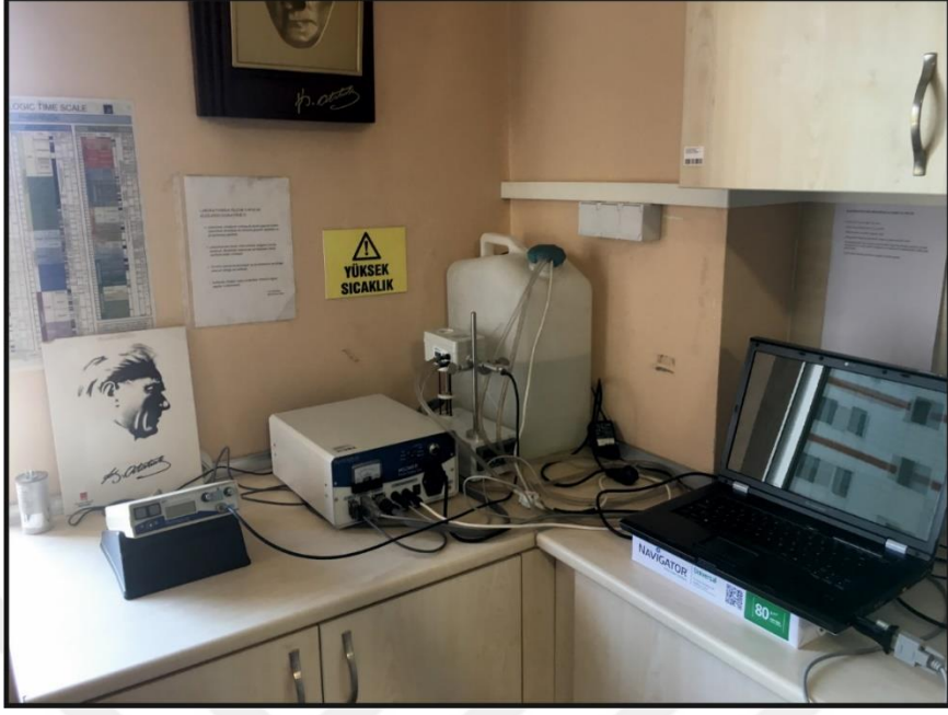
Şekil 3.16: İstanbul Üniversitesi Doç. Dr. Yılmaz İspir Paleomağnetizma Laboratuvarındaki manyetik duyarlılık ile sıcaklık değişimi ölçümleri için kullanılan Bartington MS2 Sistemi.
