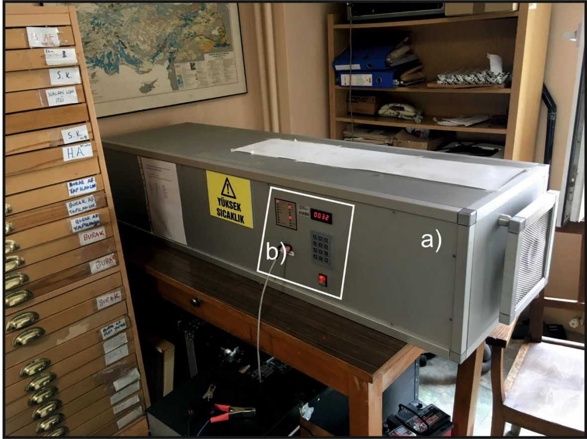
Şekil 3.6: a) İstanbul Üniversitesi Doç. Dr. Yılmaz İspir Paleomanyetizma Laboratuvarında termal temizleme için kullanılan MMTD80 termal temizleme cihazı. b) MMTD80 termal temizleme cihazına ait kontrol paneli.
