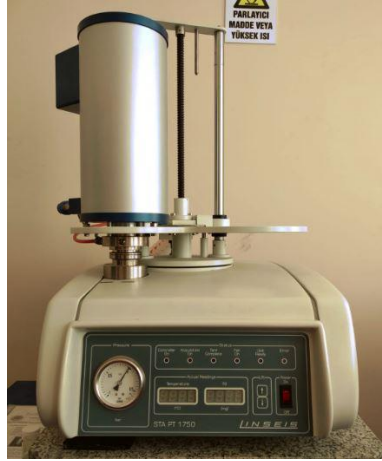
Şekil 3.2: Linseis marka PT1600 model TGA/DTA cihazı.
