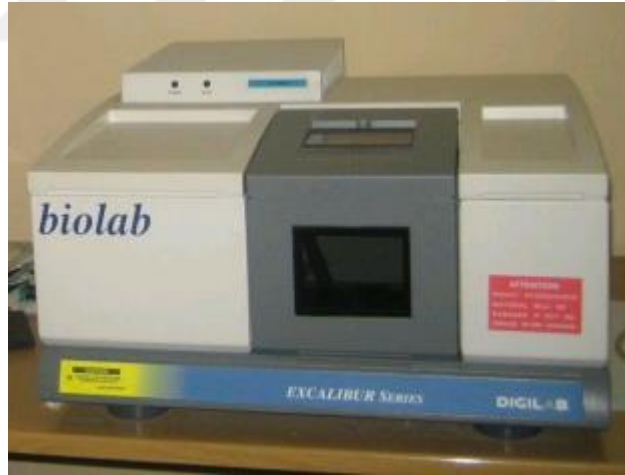
Şekil 3.3: Digilab marka Excalibur-FTS 3000 MX model FTIR cihazı.
