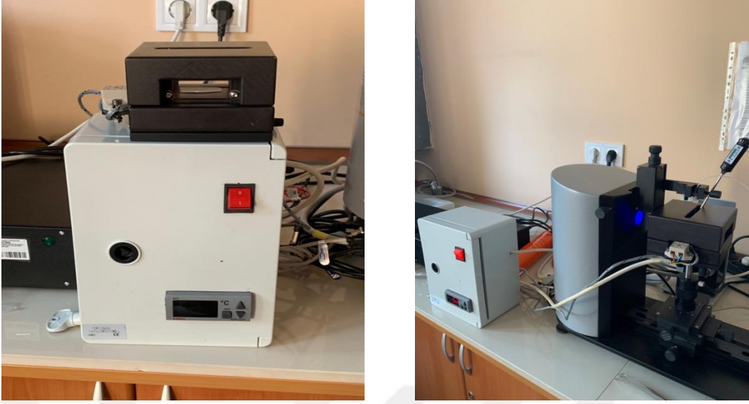
Şekil 3.24: Sıcaklık kontrol ünitesi sistemi ve kullanım biçimi görselleri.
