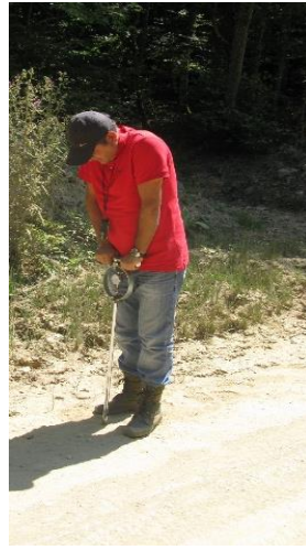
Şekil 4.12: El penetrometresi ile yol zemininin sertliği belirlenmesi
