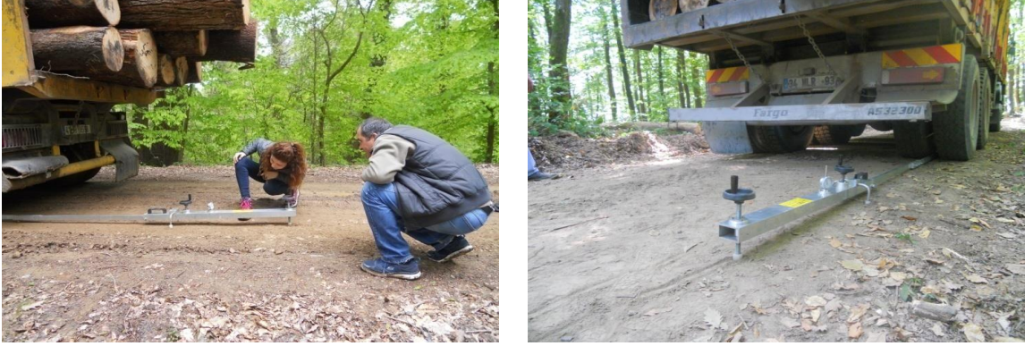
Şekil 4.8: Benkelman Beam aparatının yerleştirilmesi
