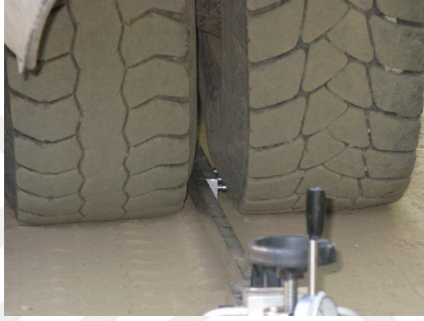
Şekil 4.11: Kamyonun arka aksındaki iki lastik arasına aparatın yerleştirilmesi
