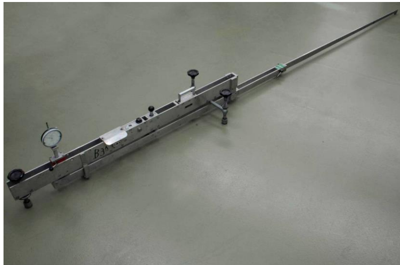
Şekil 2.18: Benkelman Beam Aparatı (Rabaiotti, 1975)
