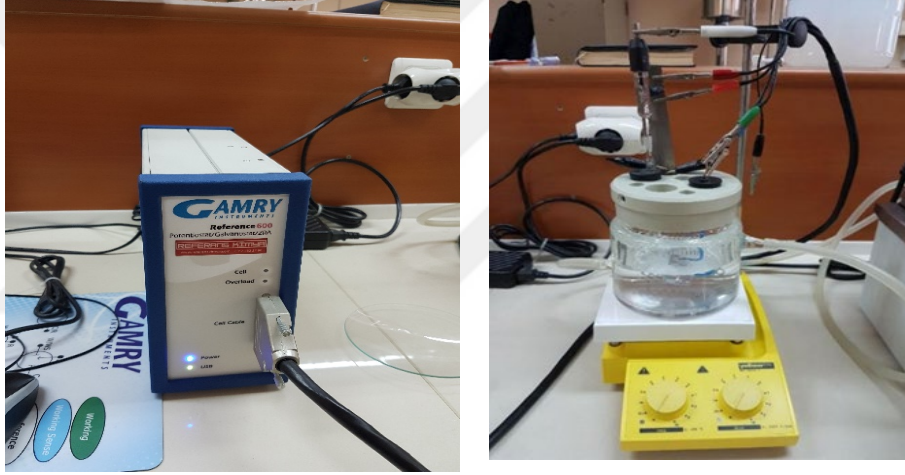
Şekil 3.1: Elektrokimyasal testlerinin gerçekleştirildiği a) Gamry Reference 600 Potansiyostat/Galvanostat b) 3 elektrotlu elektrokimyasal test hücresi.
