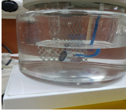
Şekil 3.2: Deneylerde kullanılan 3 elektrotlu elektrokimyasal test hücresi.
