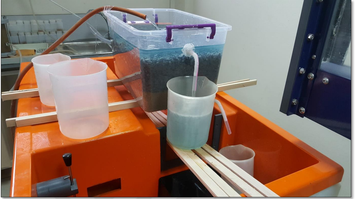
Şekil 3.1: Sahada yeni kurulan sızdırma hendeği deney düzeneğini temsil eden laboratuvar deneyi.
