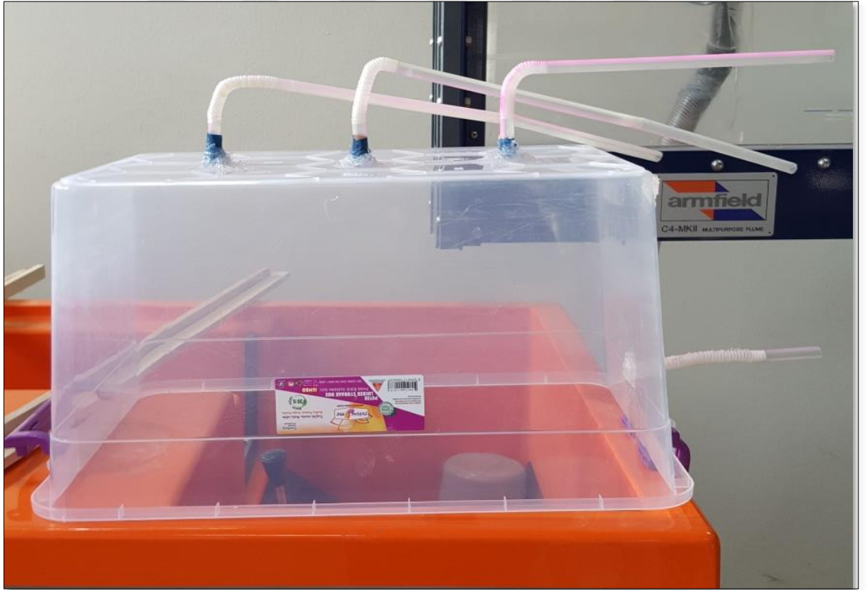
Şekil 3.2: Tabanına 3 adet delik açılmış saklama kabı.
