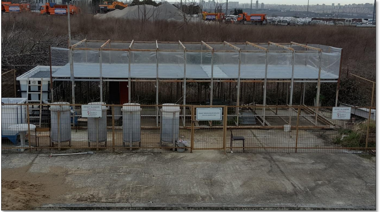
Şekil 4.4: Yağış-Havza-Sızdırma Hendeği deney düzeneği.
