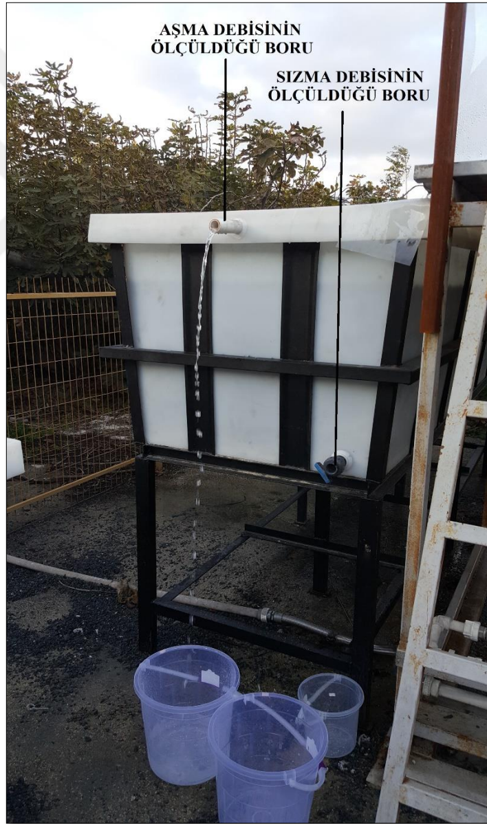
Şekil 3.23: Aşma ve sızma debisinin ölçüldüğü noktalar.
