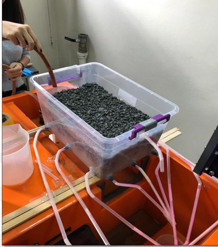
Şekil 3.3: Yan yüzeylerine 9 adet delik açılmış ve deney esnasında fotoğraflanmış saklama kabı.
