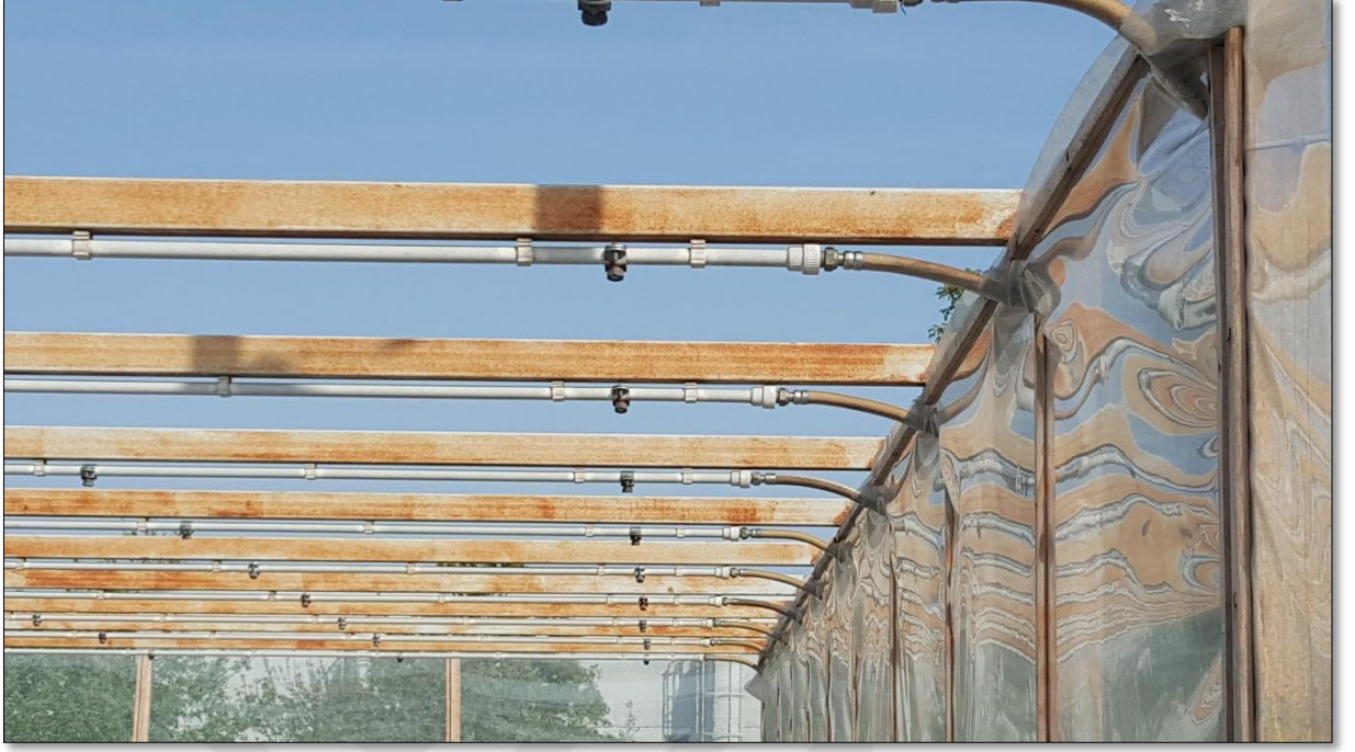
Şekil 3.10: Yapay yağış oluşturan yağmur nozulları.
