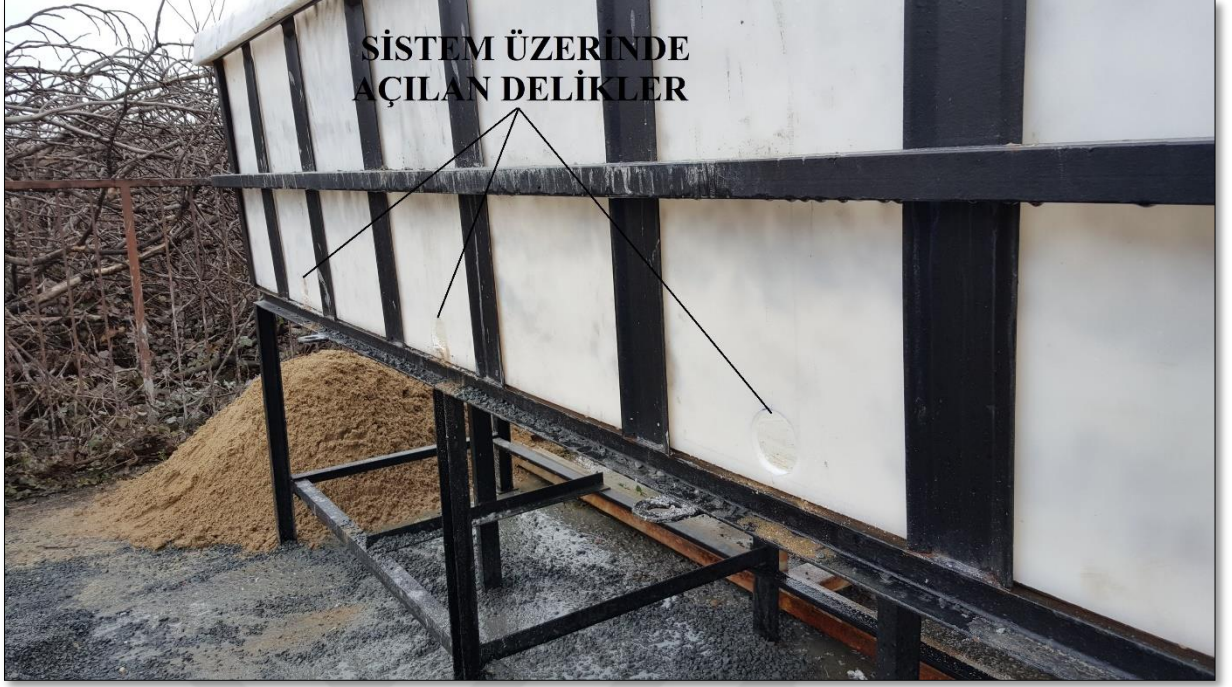
Şekil 3.25: Sızdırma hendeğinin alt kısmına açılan delikler.
