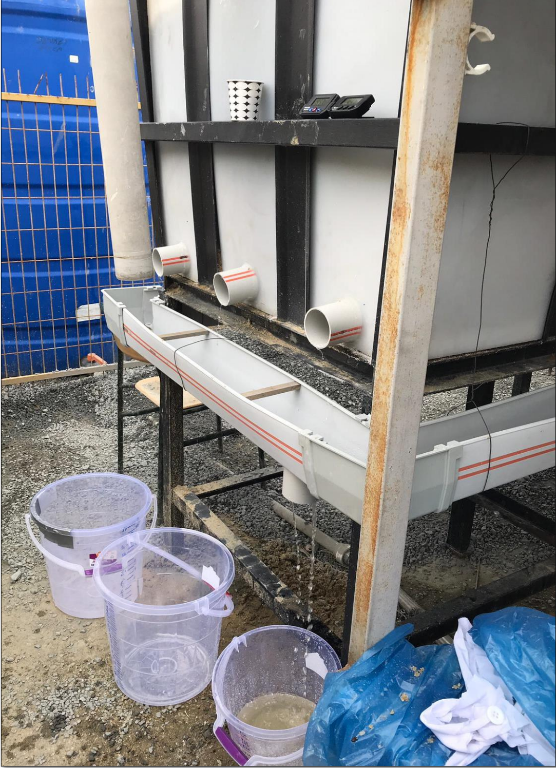
Şekil 3.31: Oluklardan toplanan sızma suyu.
