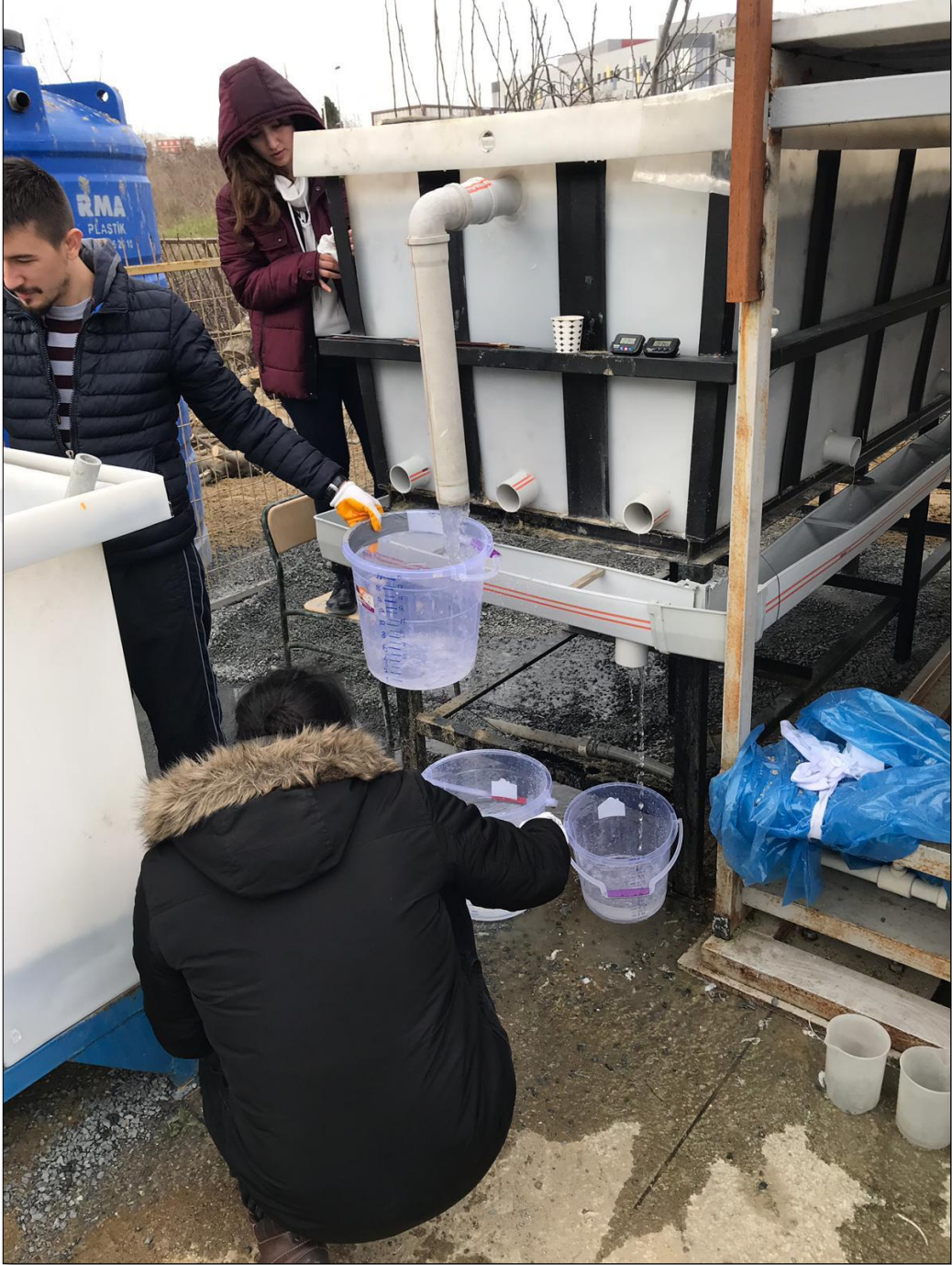
Şekil 3.32: Aşma debisinin ve sızma debisinin ölçülmesi.
