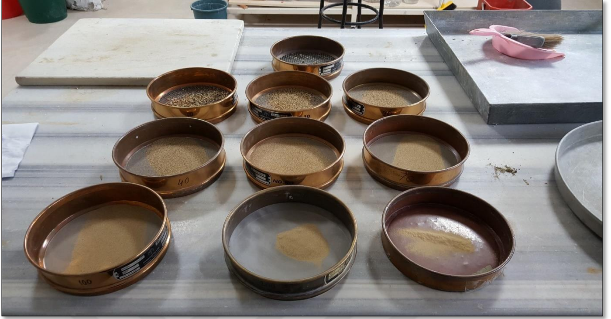
Şekil 3.5: Sızdırma hendeği içindeki kumun elek analizi deneyi.
