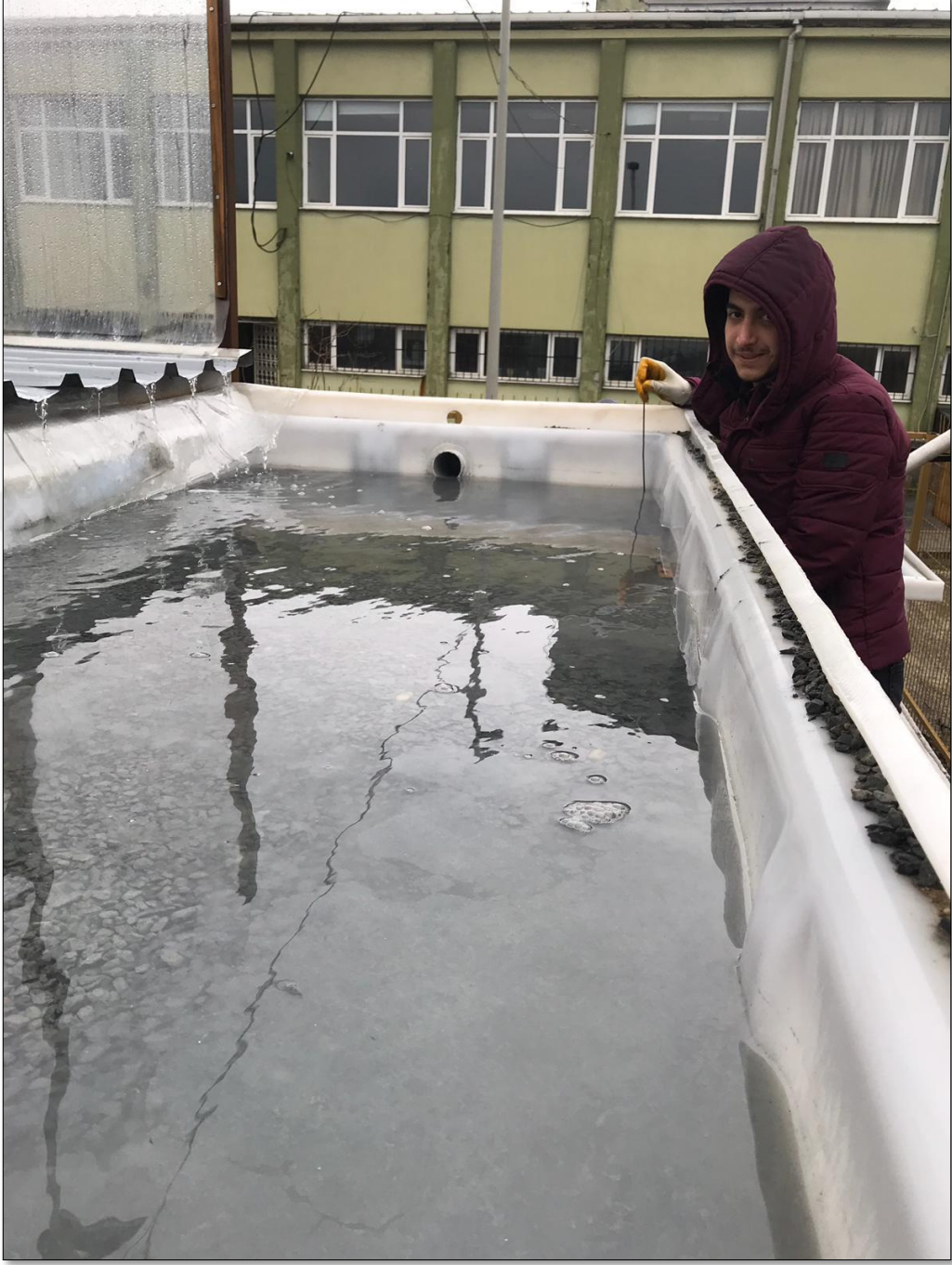
Şekil 3.33: Sızdırma hendeğinin üzerinde biriken su yüksekliğinin ölçülmesi.
