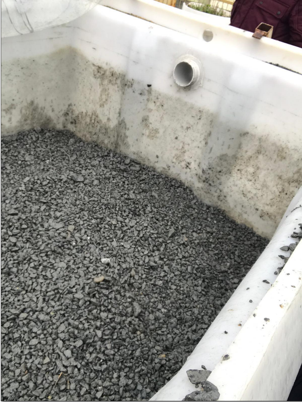
Şekil 3.34: Aşma yüksekliği 18.5 cm'ye ayarlanmış deney düzeneği.
