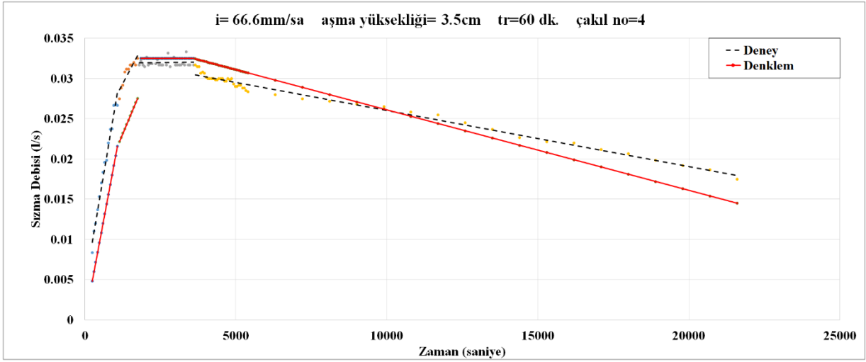
Şekil 4.53: Aşma yüksekliği 3.5 cm olan ve içinde 4 numaralı çakıl bulunduran sızdırma hendeğinde 66.6 mm/sa yağış şiddeti ile yapılan deneyden elde edilen sızma debisi ile sızma debisi için üretilen denklemden elde edilen hidrografların karşılaştırılması.
