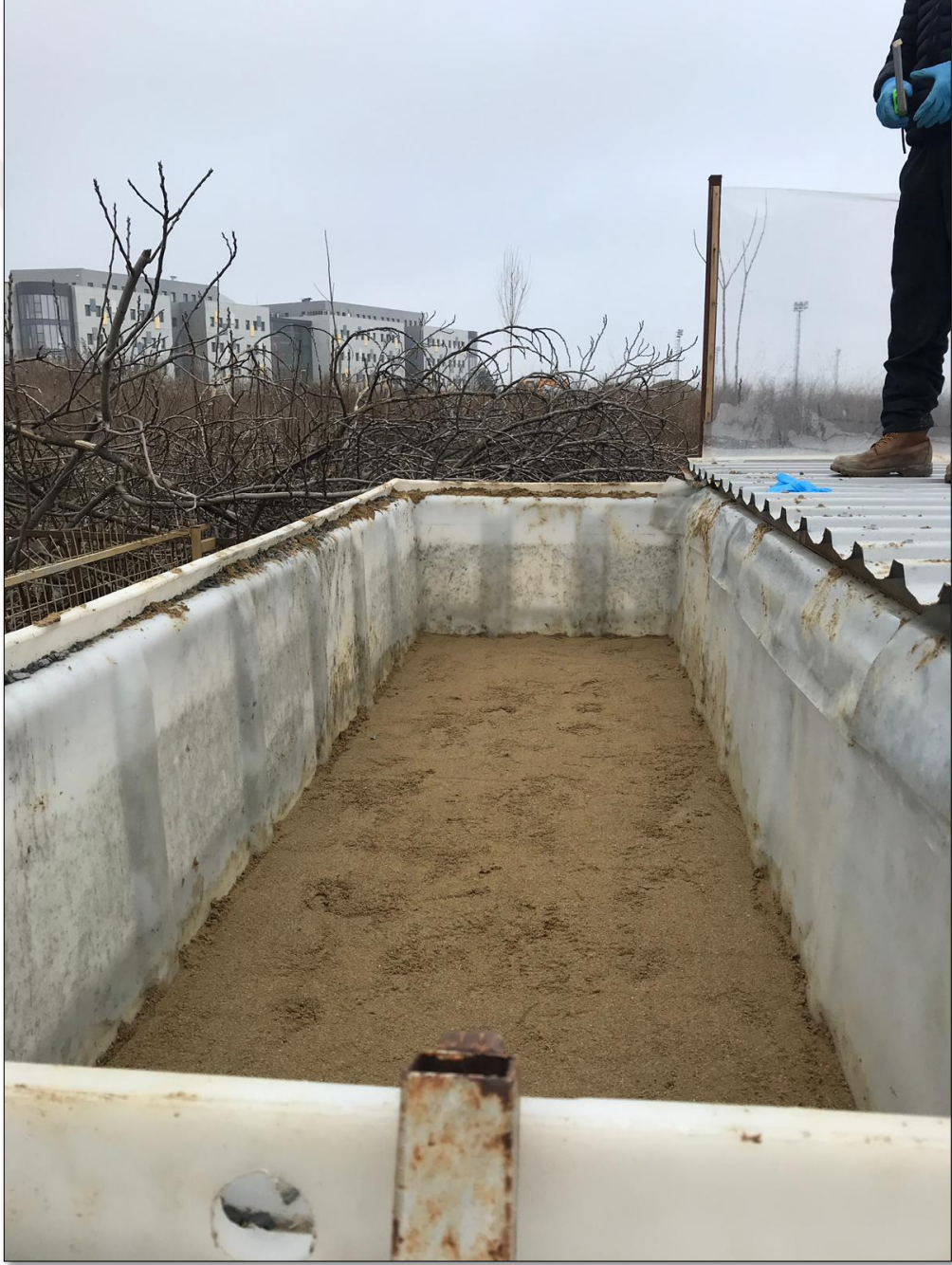
řekil 3.28: Sızdırma hendeđi içinde düzleřtirilmiř kum katmanı.
