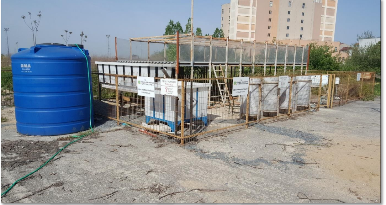
Şekil 3.8: Yağış-Havza-Sızdırma Hendeği (YHS) deney düzeneği.
