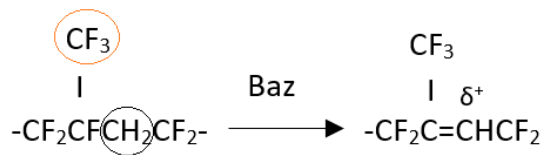
Şekil 2.31: VDF/HFP/TFE floreoelastomer için bisfenol kürlenme reaksiyon başlangıcı [16].
