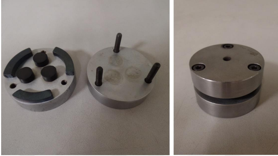
Şekil 3.13: Kalıcı deformasyon test aparatı.
