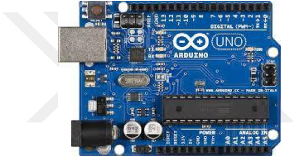
Şekil 3.11: Arduino Uno R3 kartın üstten görünüşü.
