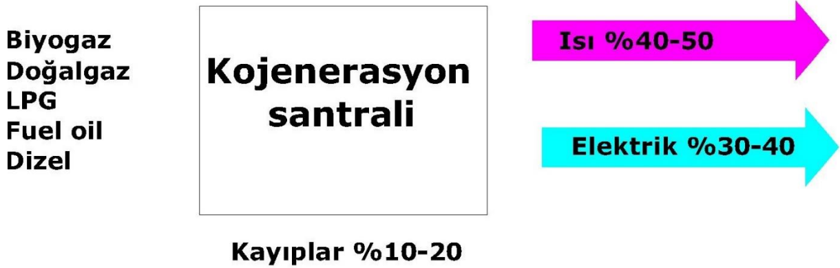
Şekil 3.6: Kojenerasyon şematik görünüşü [23].
