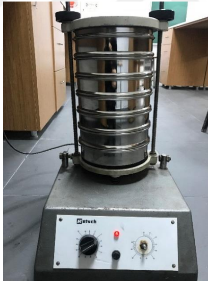
Şekil 3.8: Elek analizinin yapıldığı elekler ve elek sallayıcı
