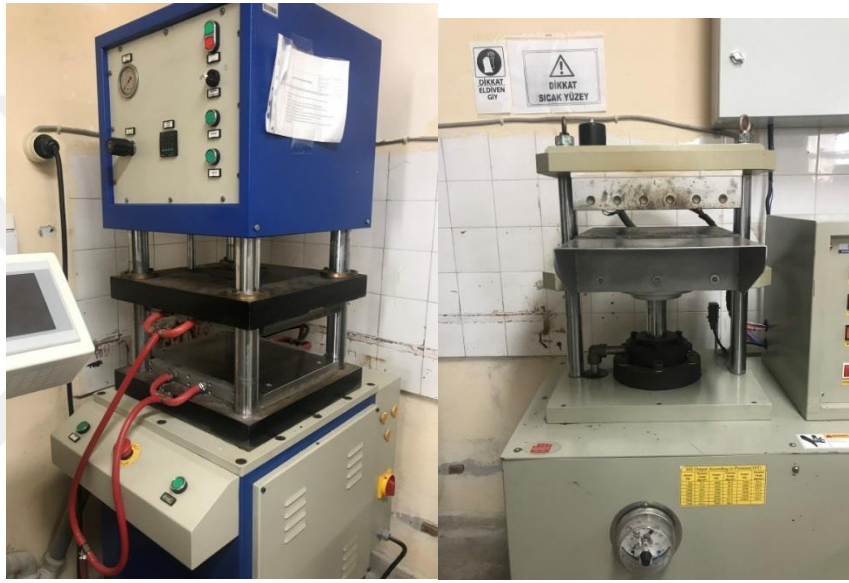
Şekil 3.5: Soğuk pres (sol) ve sıcak pres (sağ)
