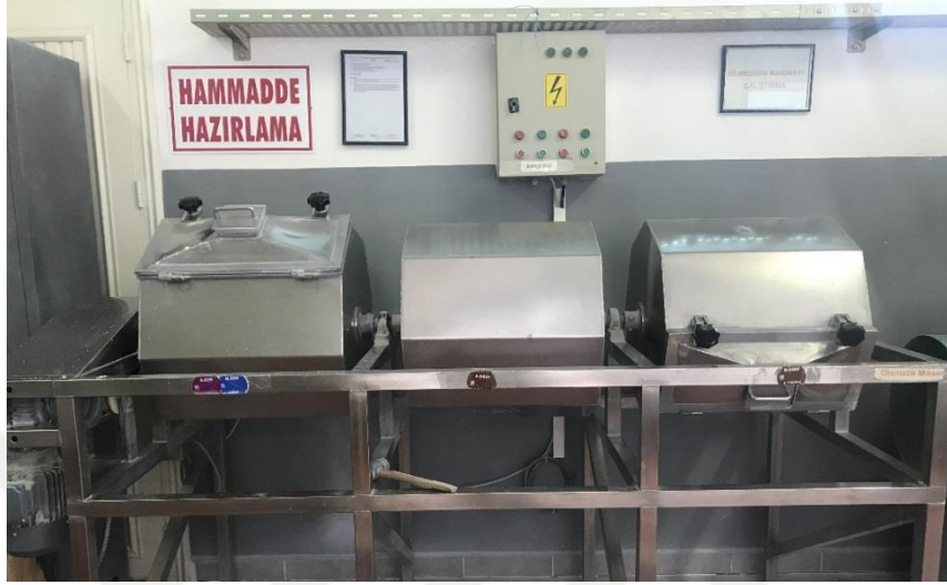
Şekil 3.2: Karışımların iyice karışmasını sağlayan karıştırıcı.
