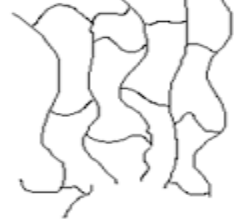
Termoset: Yüksek çapraz bağ yoğunluğu
