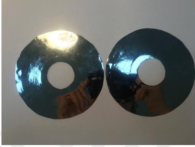
Şekil 3.12: Alüminyum folyo ile maskelenmiş gaz geçirgenliği test numuneleri
