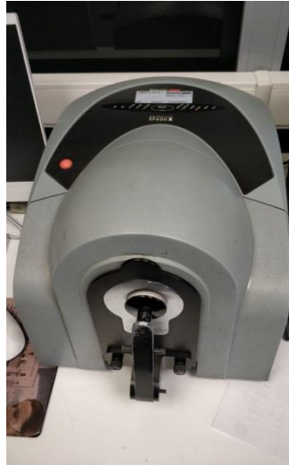
Şekil 3.14: Renk- Sararma testinin yapıldığı Spectraflash SF600x marka test cihazı
