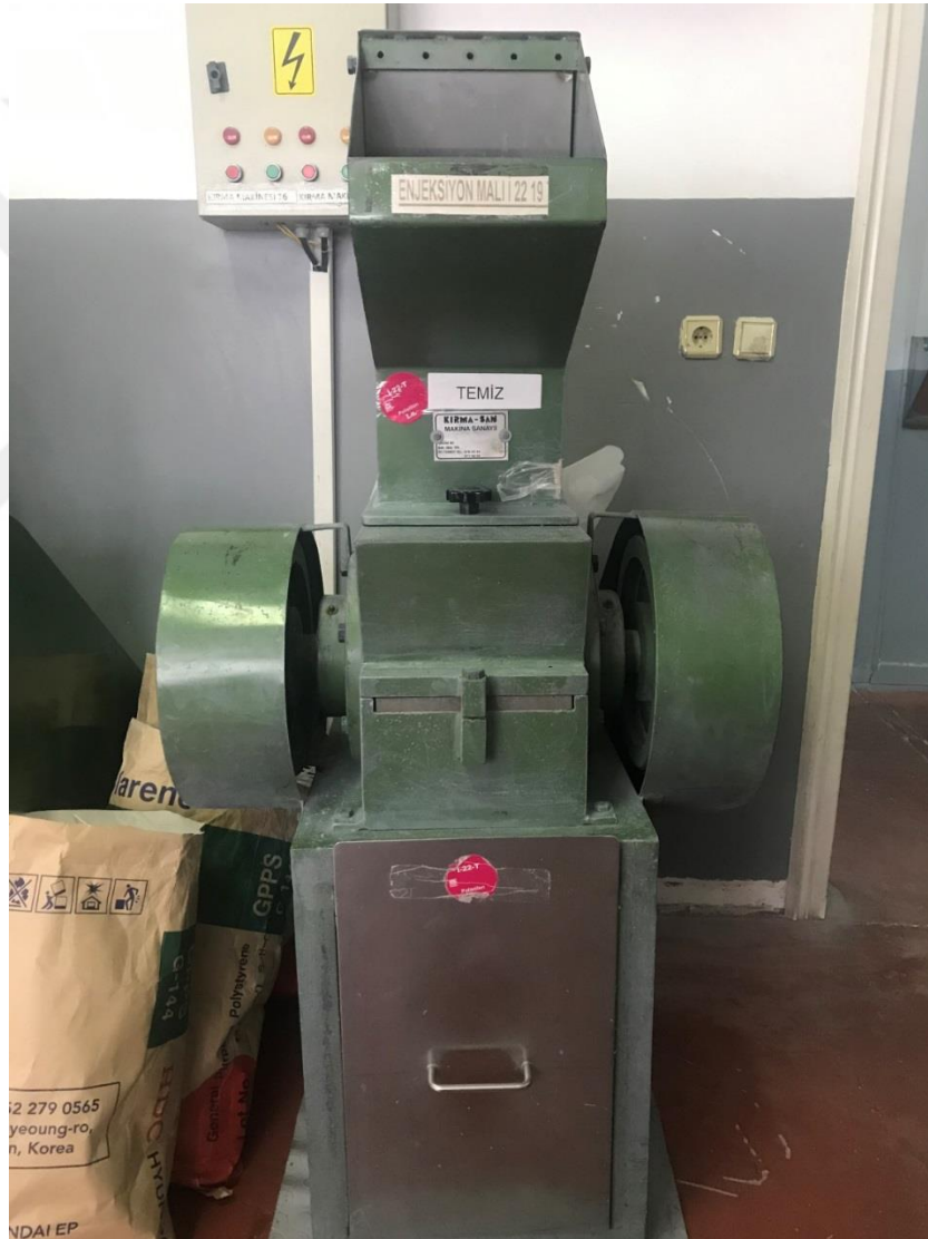
Şekil 3.1: Plastik malzemenin kırıldığı mekanik kırma makinesi.
