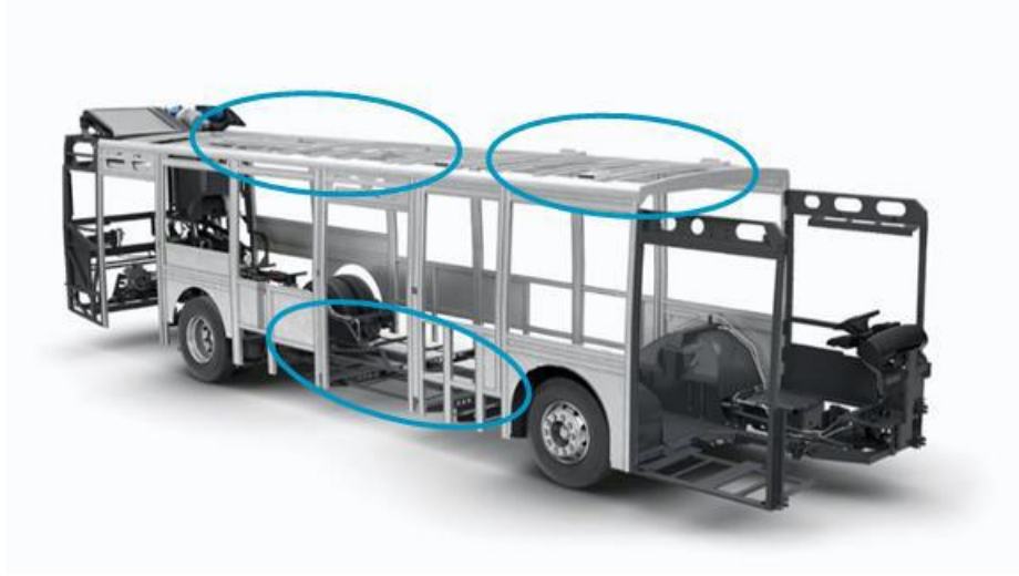
Şekil 3.4: Konsept tasarımında kullanılması düşünülen batarya paketi konumları.
