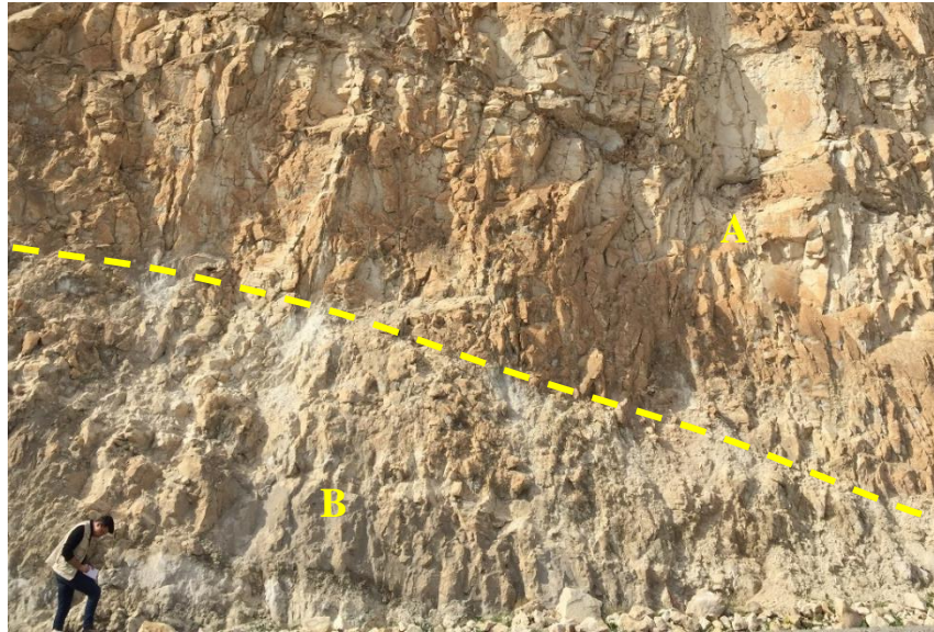
Şekil 2.14: A kesiminin sağlam kireçtaşını, B kesiminin nispeten sağlam kireçtaşını temsil ettiği mostra görünümü (I).
