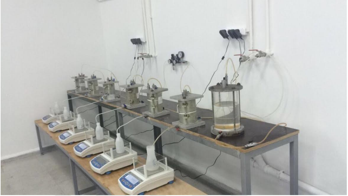
Şekil 3.3: Permeabilite deney düzeneğinin şematik fotoğrafı.
