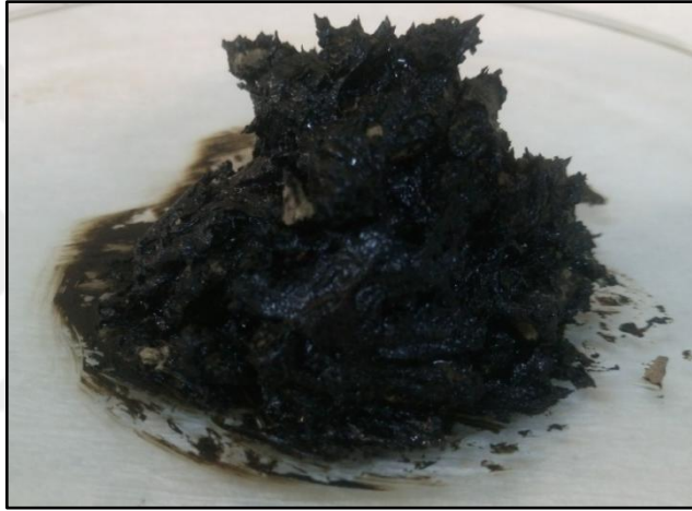
Şekil 3.3: Ham petrokimya tank dibi çamuru ve ham kuru tavuk gübresi karışımı örneği.
