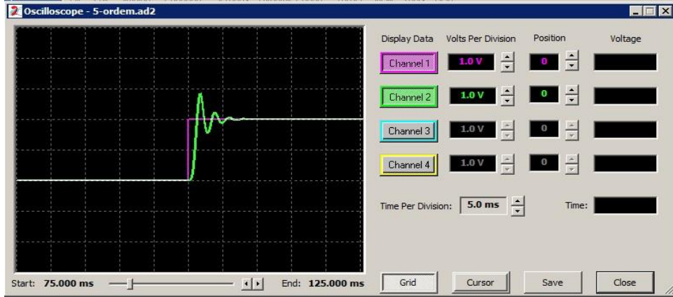
Şekil 4.3 Beşinci dereceden filtre simülör adım cevabı.
