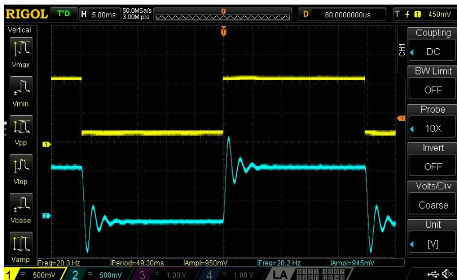
Şekil 3.20 Biquadratic filtre sistem yanıtı osiloskop görüntüsü.
