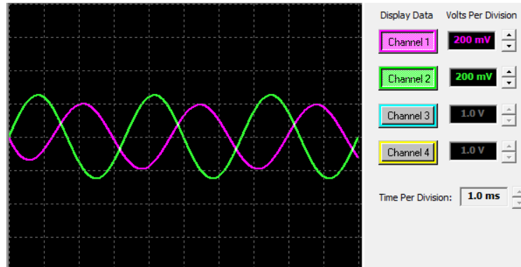
Şekil 3.15 Bilinear HPF filtre zaman alanı cevabı.
