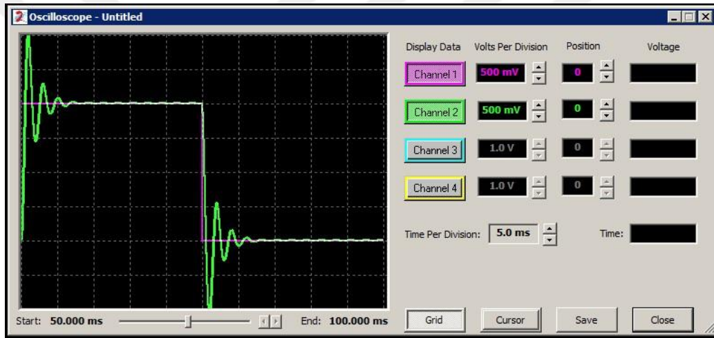
Şekil 3.19 Biquadratic filtre zaman alanı sistem yanıtı.
