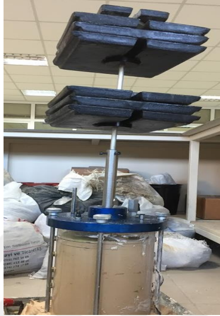
Şekil 3.34: Kaolin bulamacının 50 kPa gerilme altında konsolide edilmesi
