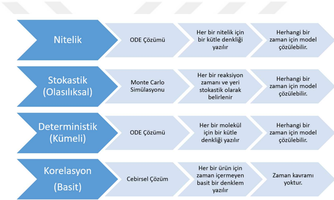
Şekil 1-2 : En basitinden en ayrıntılına birçok farklı petrol kalıntısı reaksiyon modellerinin çözümü için temel adımlar.
