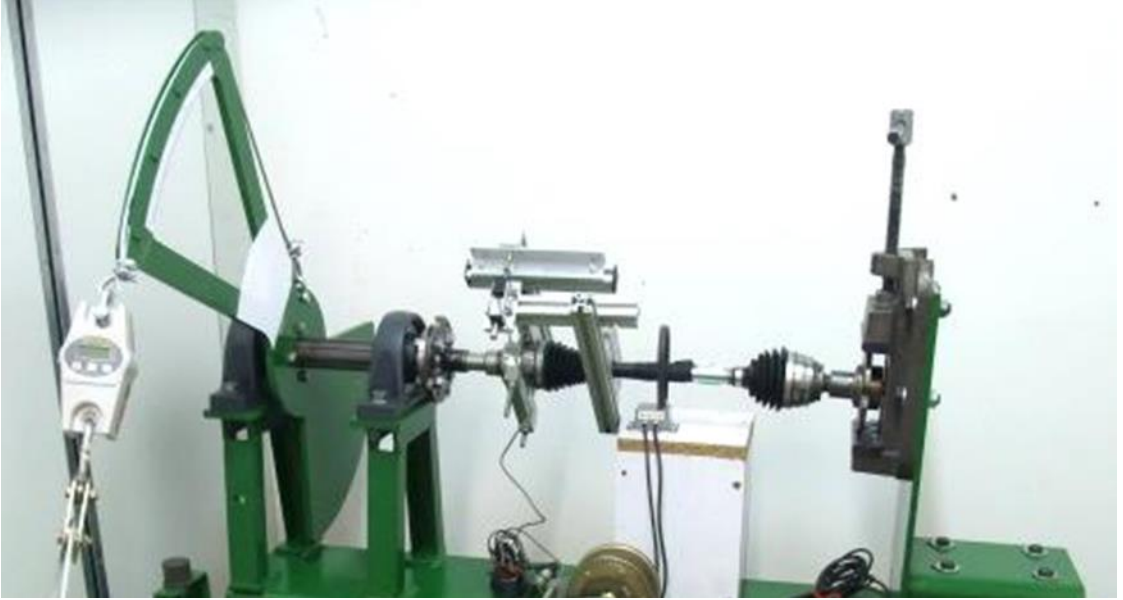
Şekil 3.5: Yarım şaft sisteminin dönme yönü yanak boşluğu ölçümü
