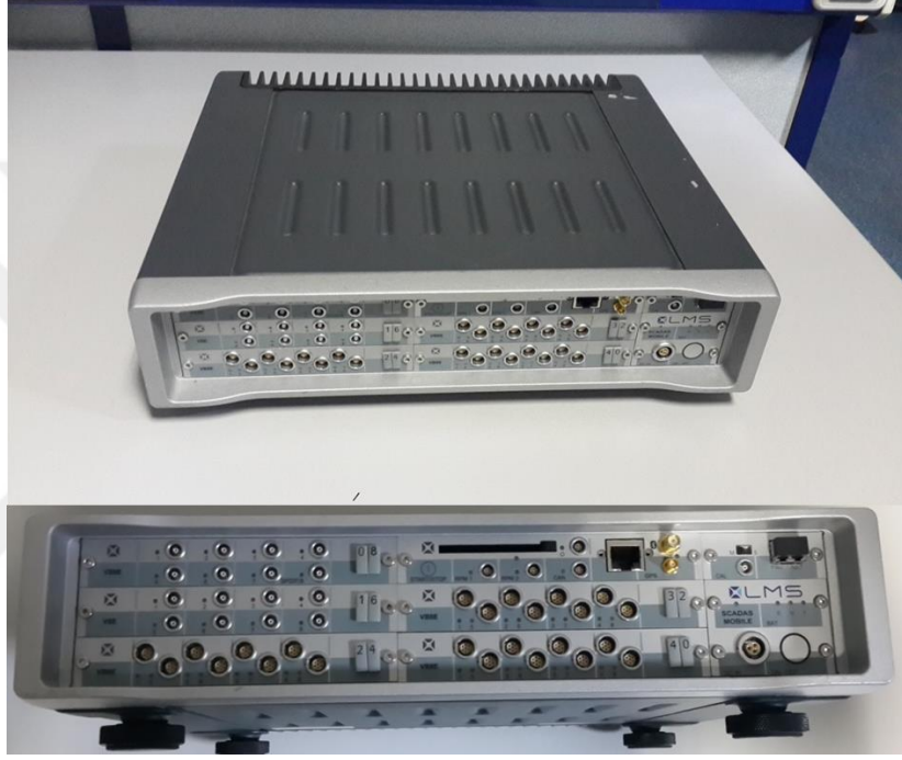
Şekil 3.14: LMS SCADAS [LMS,2018]
