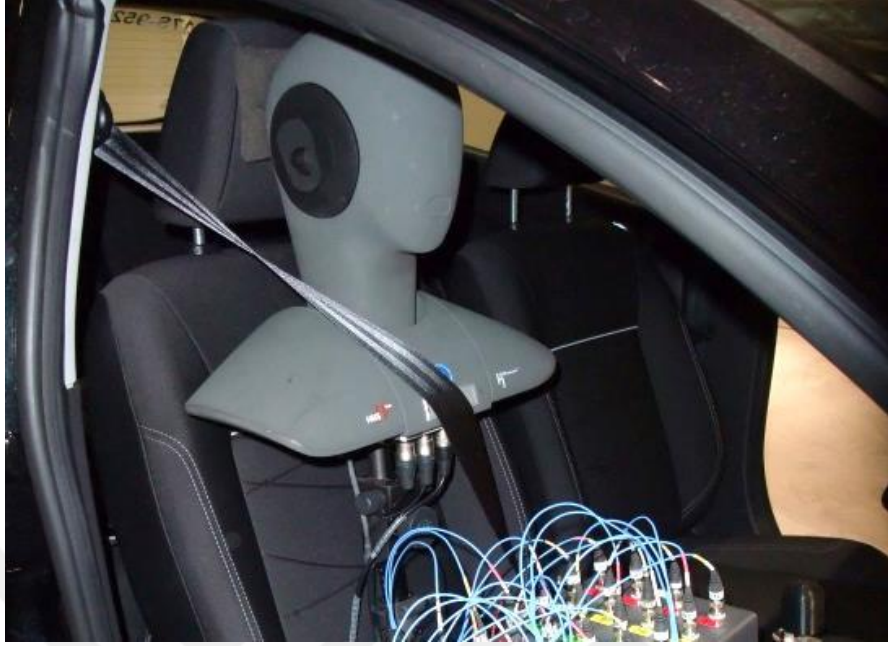
Şekil 4.8: Ön yolcu koltuğuna mikrofonların yerleştirilmesi
