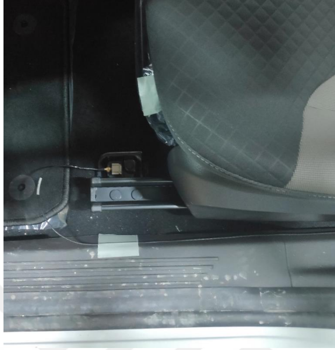
Şekil 4.10: Sürücü koltuğunun altına yerleştirilen ivmeölçer
