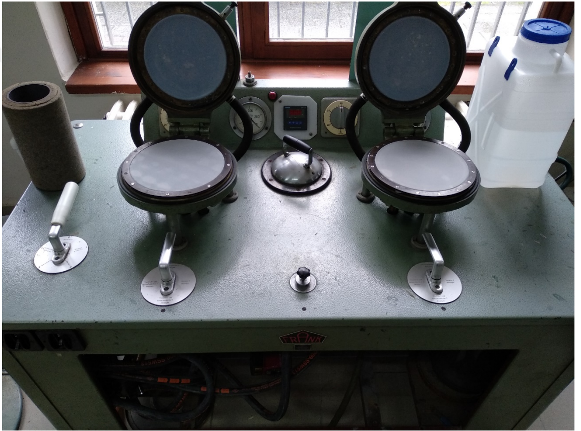
Şekil 3.4 Rapid-Köthen kâğıt makinesinin kurutma bölümü
