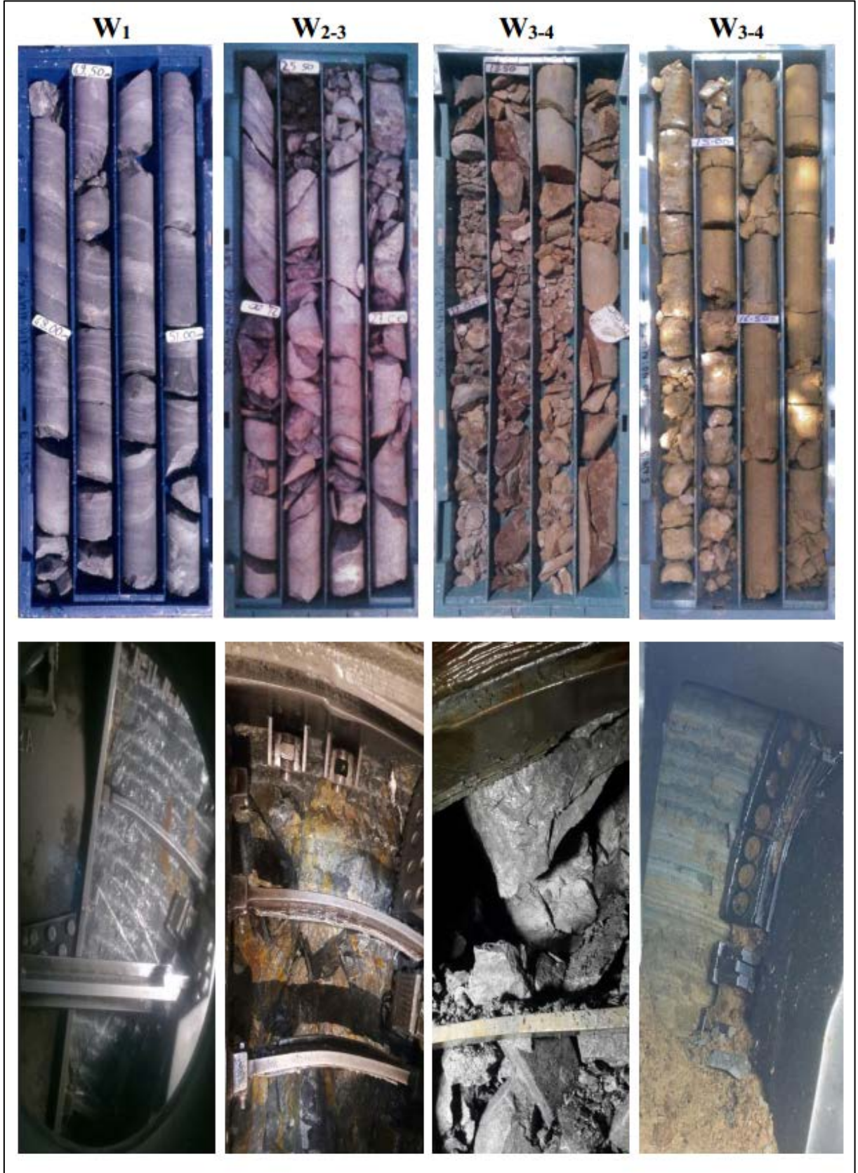
Şekil 3. 11: Ayrışma gruplarının örnek karot görünümleri ve ayna fotoğrafları.
