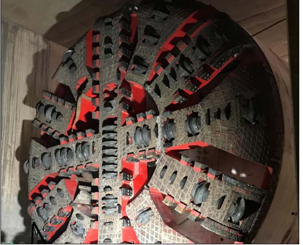
Şekil 2. 2: Kesici Kafa ve Disk Tipi Kesiciler.
