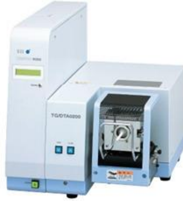
Şekil 4. 3: SEIKO SII DTA/TG termal analiz cihazı.
