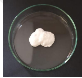
Şekil 4.3: Liyofilizatörde kurutulmuş ürün.
