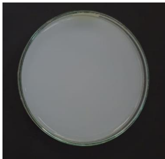
Şekil 4.34: Liyofilizatörde kurutulmuş nanojel.
