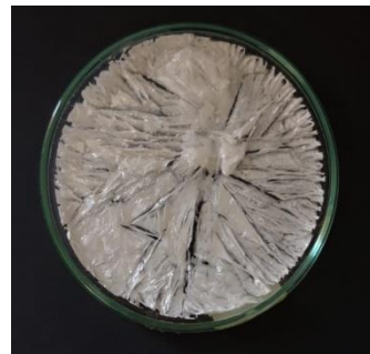
Şekil 4.34: Liyofilizatörde kurutulmuş nanojel.
