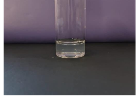
Şekil 4.57: UCST üstündeki sıcaklıklarda nanojel dispersiyonunun görüntüsü.
