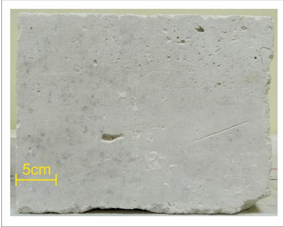
Şekil 4.12: Pınarhisar küfeki taşının makro örnekteki görünümü.
