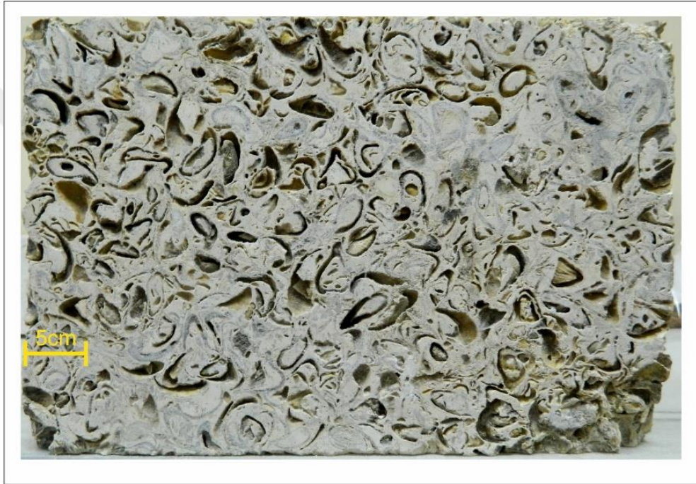
Şekil 4.15: Sülođlu küfeki taşının makro örnekteki görünümü.
