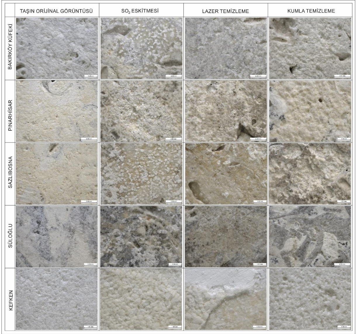
Şekil 4.25: Çalışılan örneklerin SO 2 eskitme uygulaması sonrası temizleme çalışmaları etkilerinin binoküler mikroskop altında görüntüleri.
