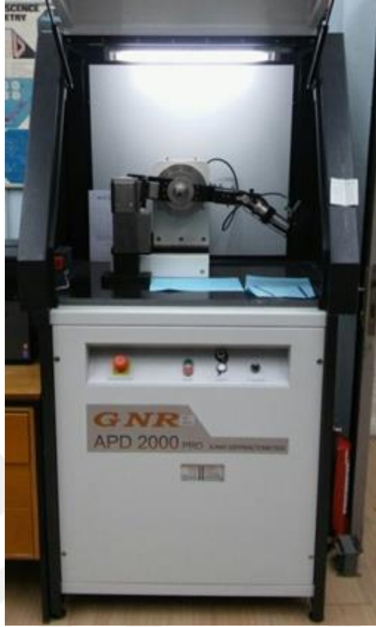
Şekil 3.2: Jeoloji mühendisliği bölümü, Mineraloji – Petrografi anabilim dalında bulunan XRD cihazı.
