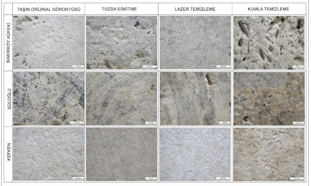
Şekil 4.24: Çalışılan örneklerin Tuzda eskime uygulaması sonrası temizleme çalışmaları etkilerinin binoküler mikroskop altında görüntüleri.
