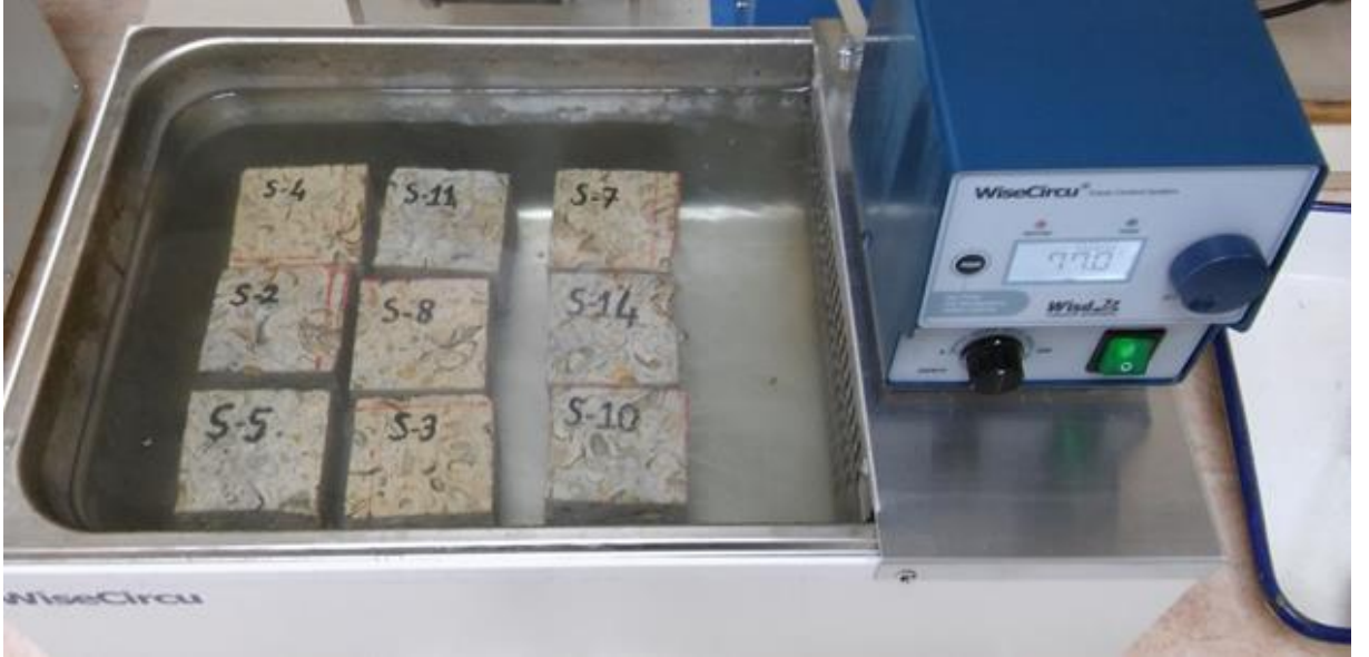
Şekil 3.9: Süloğlu bölgesine ait örneklerin kaynar suda su emme deneyinden bir görünüm.
