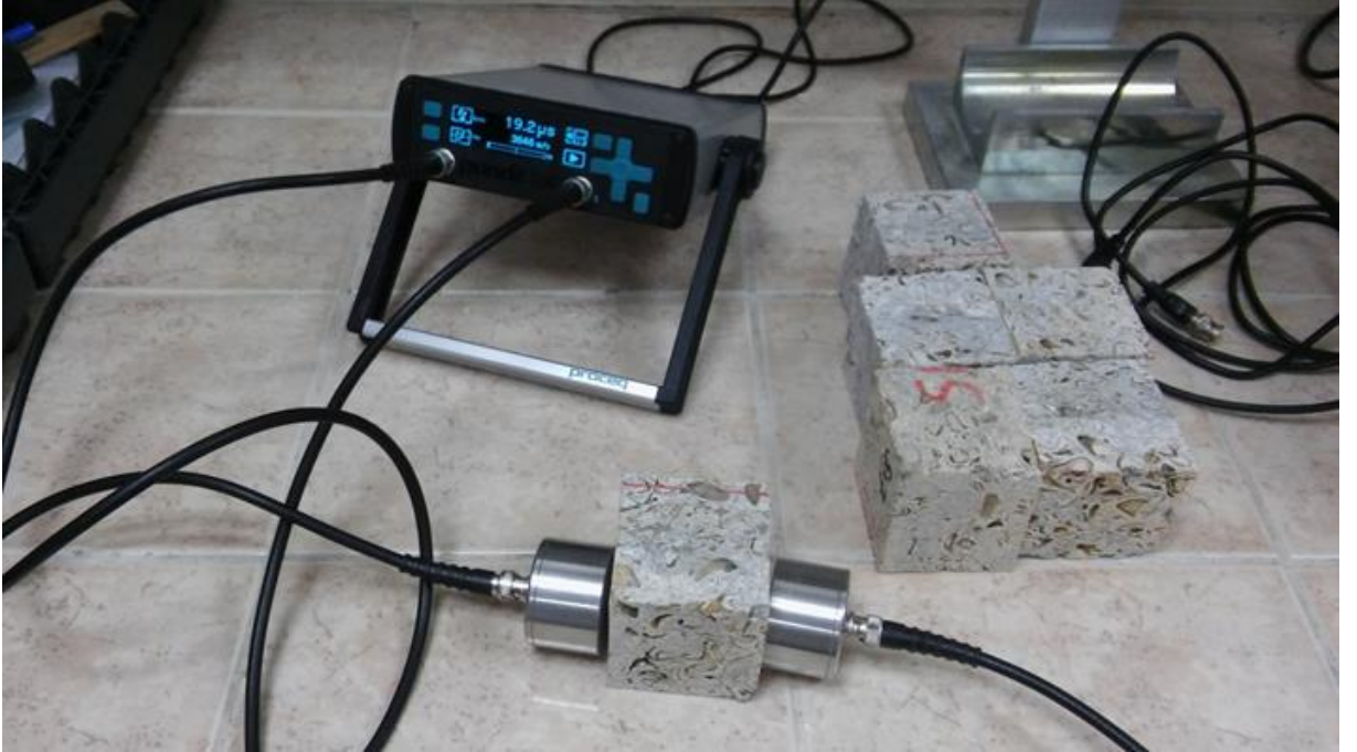
Şekil 3.12: Örneklerin Pundit cihazı ile ses geçiş süreleri ölçümü.
