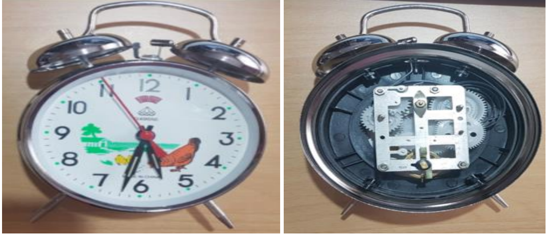
Şekil 3-5: Esneklik Potansiyel Enerjisinin Kinetik Enerjiye Dönüştüğü Mekanik Saat
