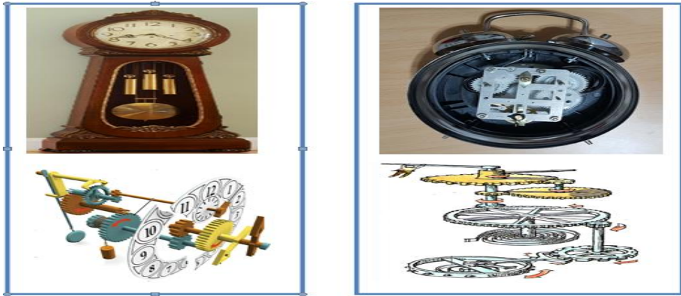
Şekil 3-3: İki Mekanik Saatin Çalışma Mekanizmasına Ait Görseller (Encyclopædia Britannica, Inc., 2008 ; Du and Xie, 2013, s. 42)
