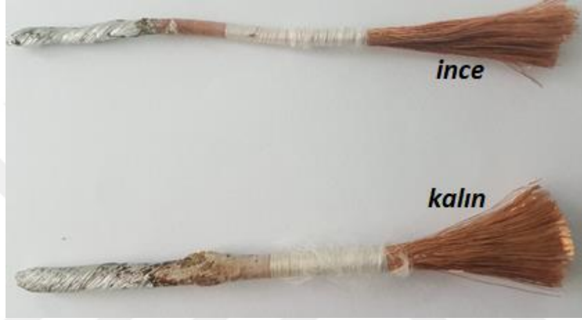
Şekil 3.18: Üstte 450 sarım altta 1000 sarım Litz kablosu gösterimi.
