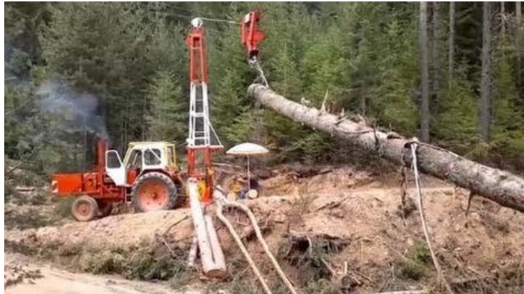
Şekil 2.6: Kablolu hatlar ile bölmeden çıkarma (URL-1, 2016)
