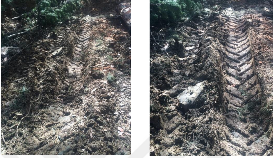
Şekil 4.5: Traktörün 15. ve 20. geçişlerinden sonraki toprağın deforme olmuş hali
