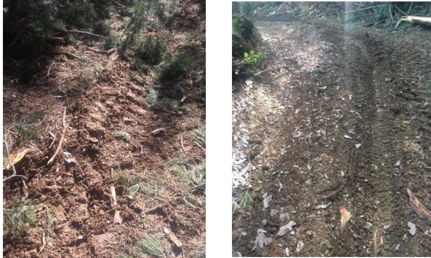
Şekil 4.4: Traktörün 5. ve 10. geçişlerinden sonraki toprağın deforme olmuş hali
