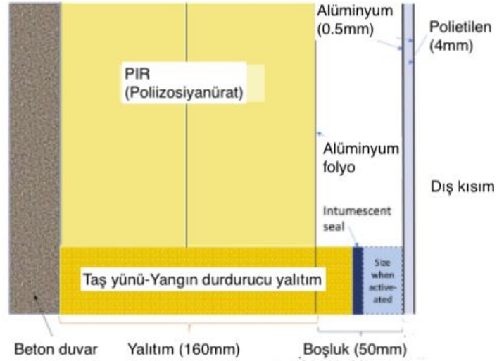
Şekil 2.17: Grenfell Tower'da cephe sistemi [54].
