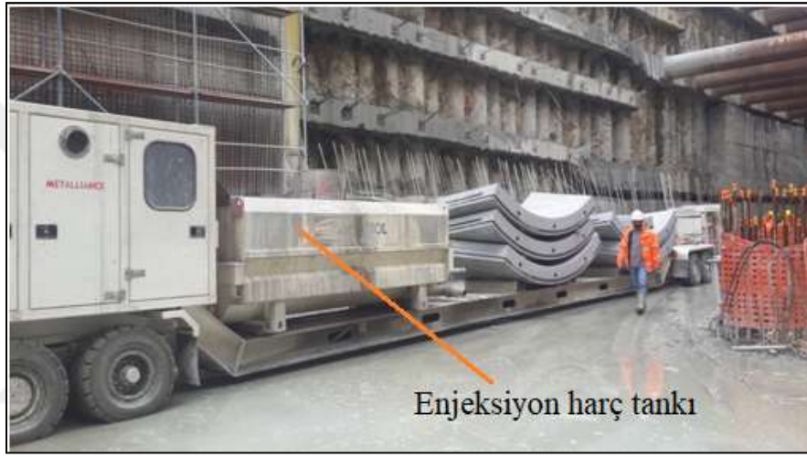
Resim 3-3: Tünel içi çok amaçlı servis aracı (MSV) ve enjeksiyon transferi için enjeksiyon harç tankı
