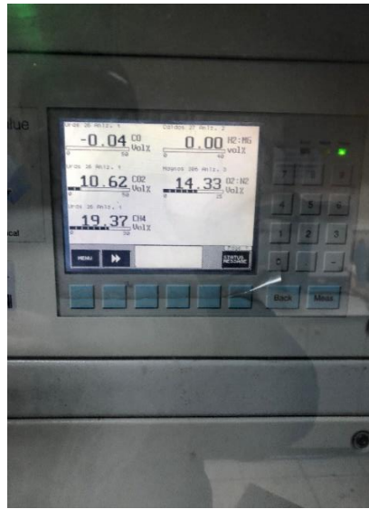
Foto 3. Anaerobik reaktörlerden çıkan biyogaz kompozisyonunu belli başlı gazlara göre ölçen On-line GC ekran görüntüsü
