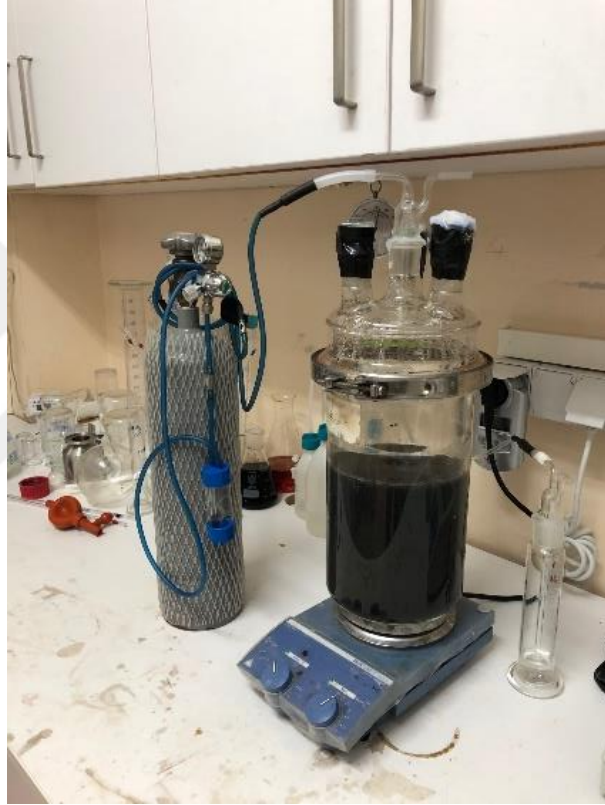
Foto 1. Asidifikasyon (ön asitleşme) reaktörü (Mezofilik sıcaklıkta)
