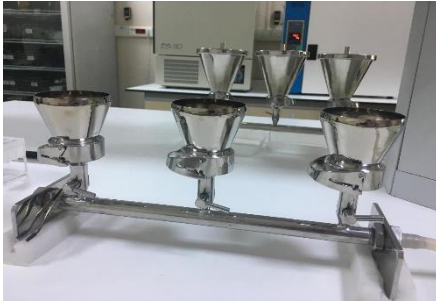
Şekil 2.4: Membran filtrasyon sistemi ve 0,45 \mu 'luk gri filtre kağıdı
