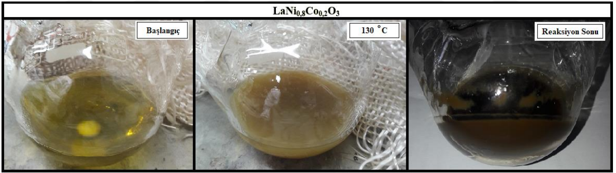
Şekil 3.5: \text{LaNi}_{0.5}\text{Co}_{0.5}\text{O}_3 perovskit katalizörü reaksiyon aşamaları.
