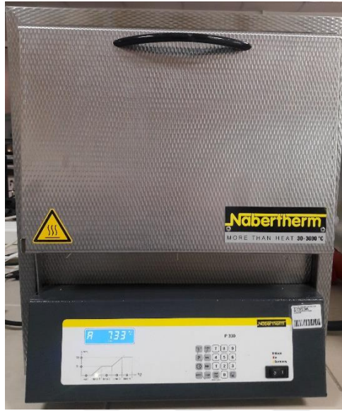
Şekil 3.2: Yüksek sıcaklık kalsinasyon fırını.
