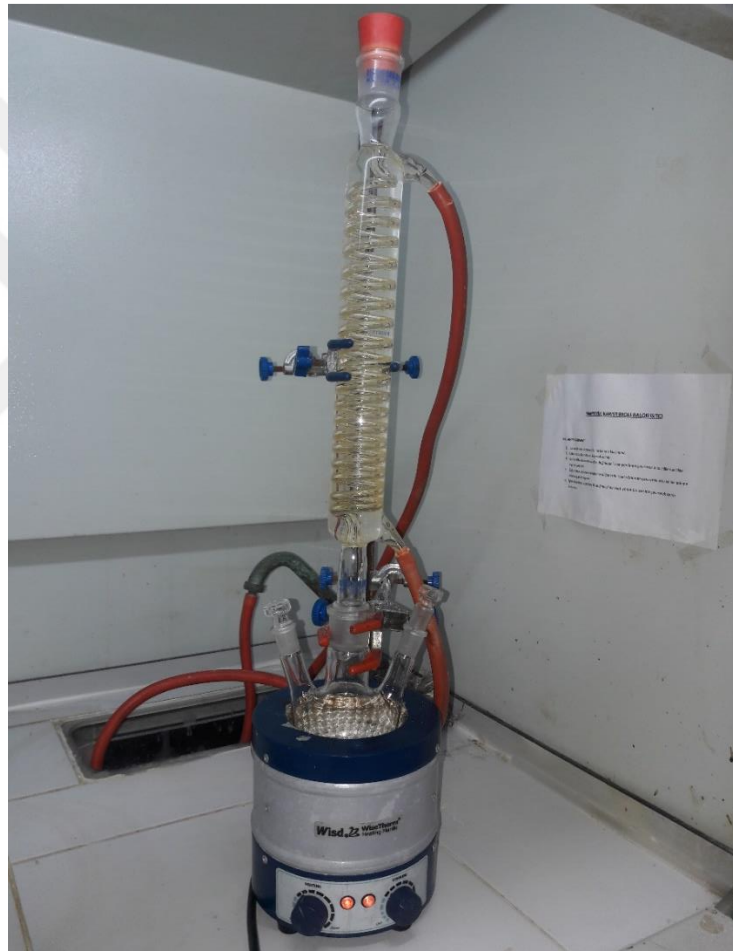
Şekil 3.3: Poliöl yöntemi deney düzeneği.
