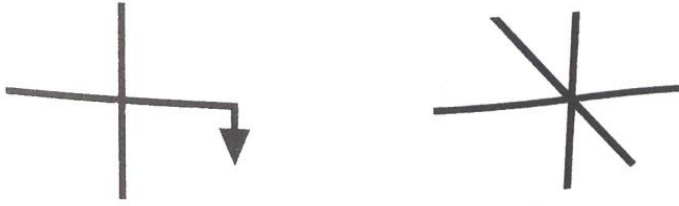
Resim 3.98. Bozulan dengenin, denkleştirme ağırlığı ile düzeltilmesi ve karşı sonucu. 186
