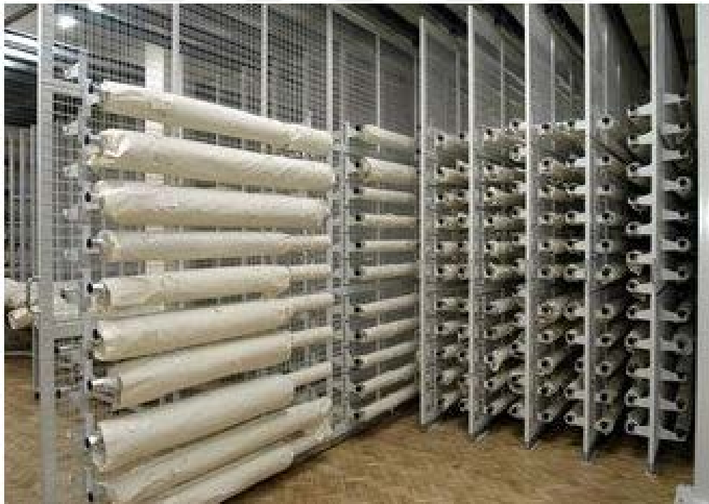
Fotoğraf 7.4. Rulo edilen eserler için hazırlanmış raf sistemi,(Koleksiyonun kime / hangi müzeye ait olduğuna dair bilgi yok ).
