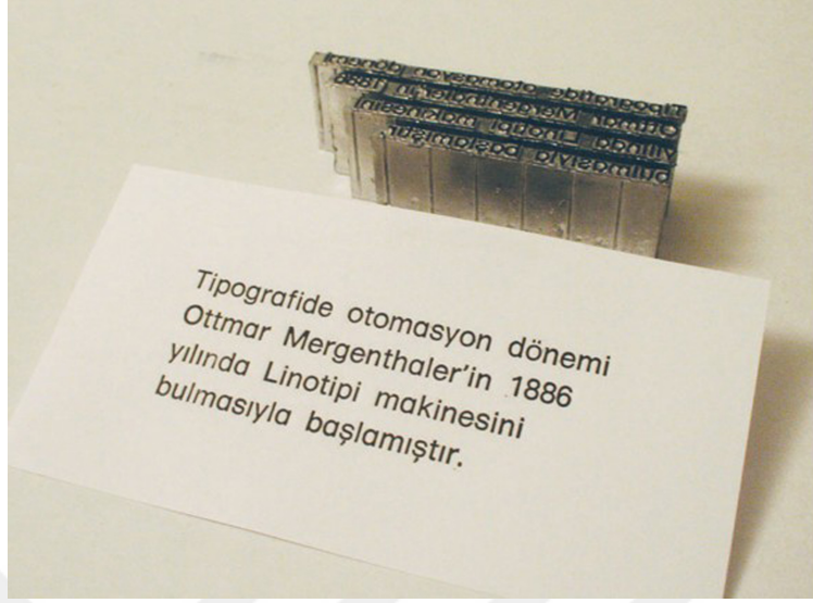
Şekil 20. Linotip makinesinde dökülmüş kurşun harf kalıpları ve baskı sonucu.
