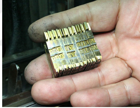
Şekil 18. Negatif harf döküm kalıbı (matrix).
