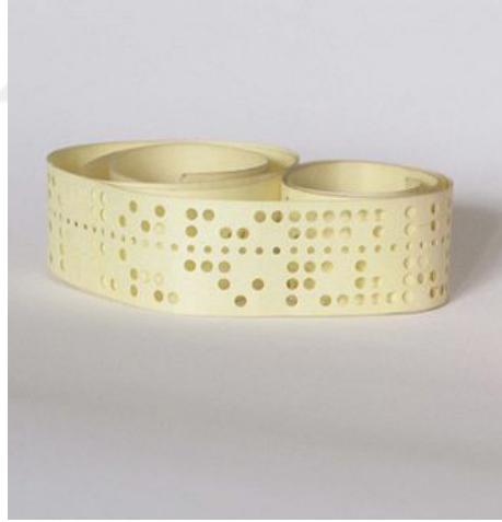
Şekil 24. Monotip makinesi klavyesinde yazılanlar, bir mekanizma ile şeritlere aktarılırdı.
