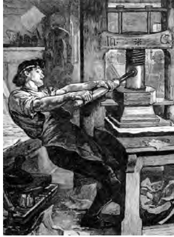
Şekil 4.106 : Gutenberg'in icat ettiği baskı sistemi, üzüm preslerinden ilham alınarak tasarlanır ve insan gücüne dayalıdır.
