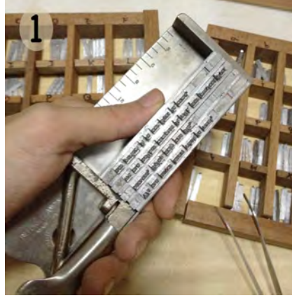
Şekil 4.142 : Baskı harflerinin dizilmesi
