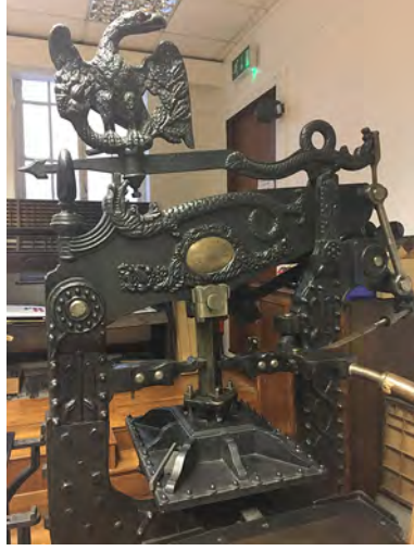
Şekil 4.135 : Kaldıraç mekanizması olan presler tek bir hareket ile çok güçlü bir baskı yaratabilirler.
