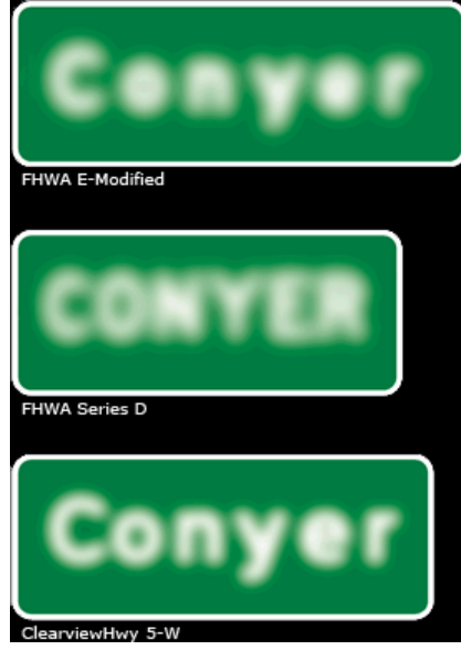
Şekil 4.347 : Majüskül-minüskül Highway Gothic Majüskül Highway Gothic ve majüskül-minüskül Clearview ile yazılan sözcüklerin yansıma nedeniyle parlayarak halelenmesinin karşılaştırılması
