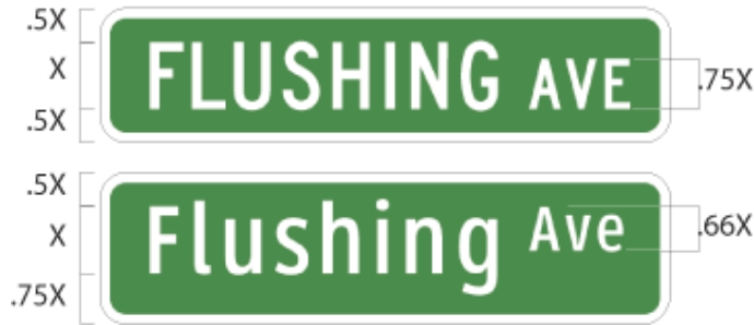
Şekil 4.353 : Üstte Highway Gothic, altta Clearview, Her iki yazı karakterinin trafik levhalarına yerleşimi ve harf yükseklikleri
