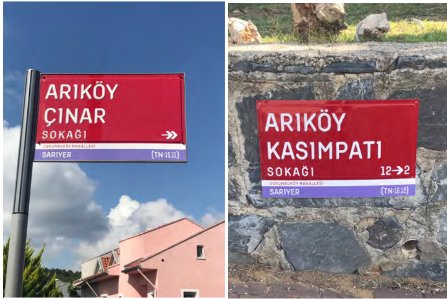
Şekil 4.365 : (Solda) Sokak adının yer aldığı direk tipi tabelada ilçe, mahalle isminin renk kodu ile örneklenmesi ve Kent yazı karakterinin kullanımı (Sağda) Sokak adının yer aldığı duvar tipi tabelada ilçe, mahalle isminin renk kodu ile örneklenmesi ve Kent yazı karakterinin kullanımı
