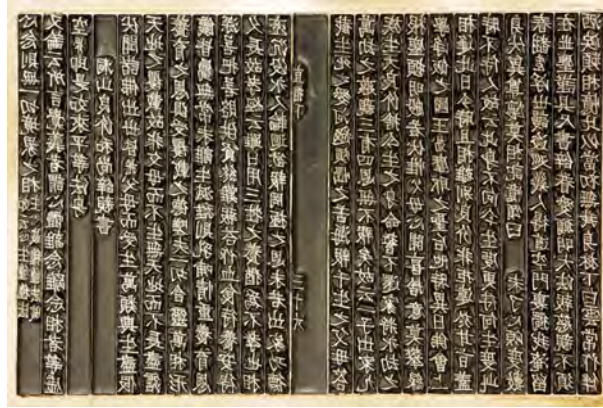
Şekil 4.102 : Hareketli bronz yazı kalıpları Çin'de hareketli kalıplara dayalı baskı sisteminde ilk olarak ahşap, ardından seramik ve son olarak da metal kalıplar kullanılır.
