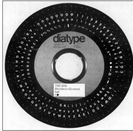
Şekil 4.158 : Fotodizgide kullanılan master disk
