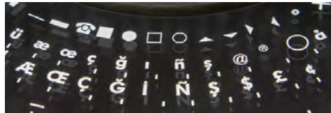
Şekil 4.159 : Fotodizgide kullanılan master diskten detay
