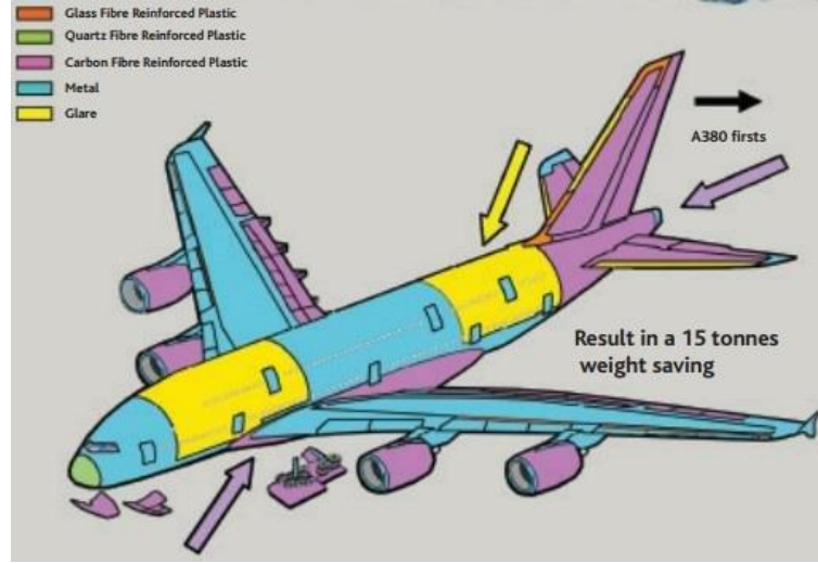
Şekil 2.2.: A380 yolcu uçağının malzeme bileşimi [13].
