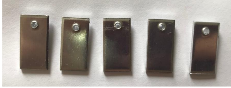
Şekil 3.1: İşlem öncesi kullanılan altlık malzemelerin makro görünüşleri.
