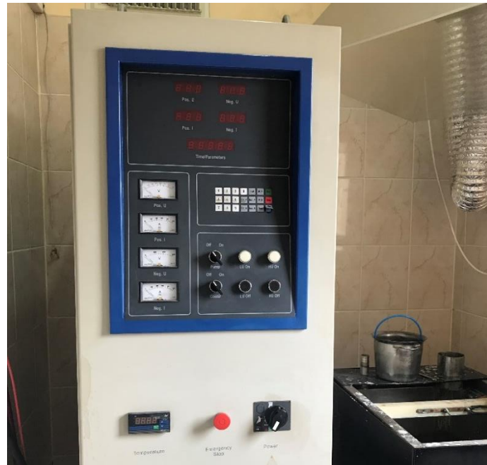
Şekil 3.2: Proseste kullanılan mikro ark oksidasyon cihazı.
