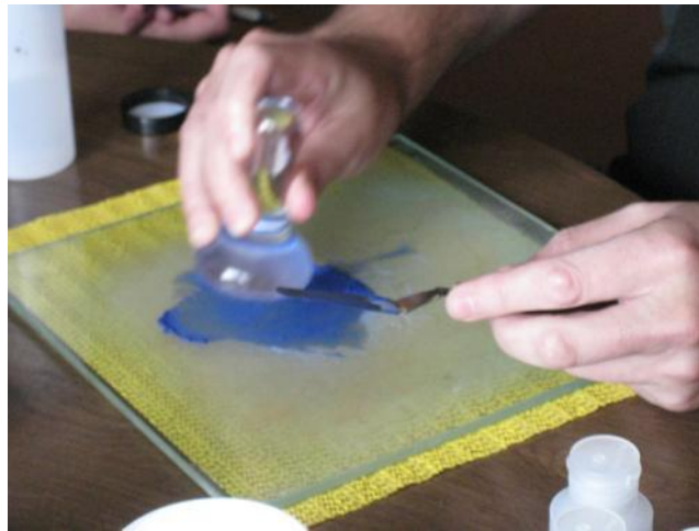
Resim 109: Toz pigmentlerin suyla ezilerek hazırlanması.
