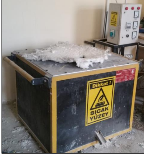
Şekil 3.2: Deneylerde kullanılan rezistanslı ertitme fırını.
