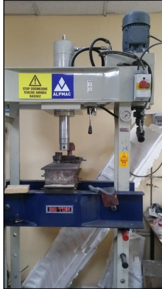
Şekil 3.1: Tozların peletlenmesinde kullanılan dikey tip 30 ton kapasiteli pres.
