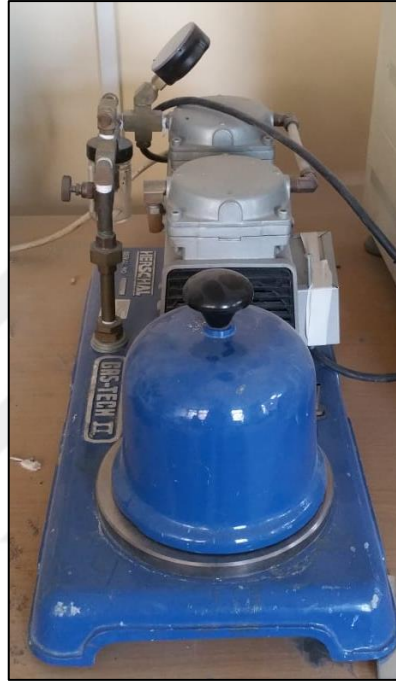
Şekil 3.4: Vakum altında katılaştırmak için kullanılan RPT cihazı.
