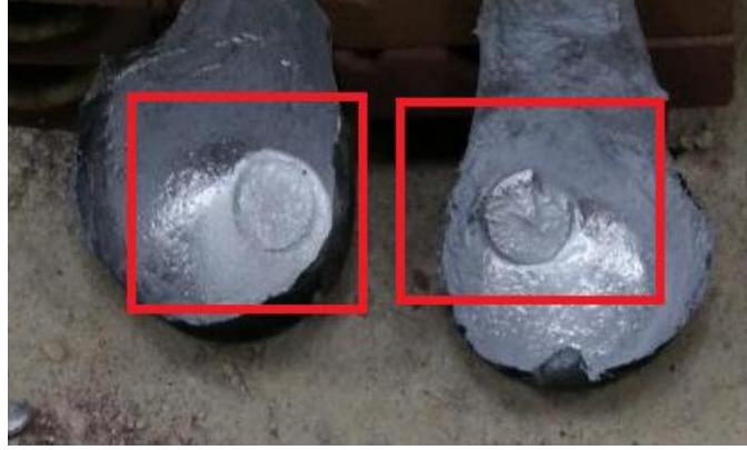
Şekil 4.26: Dökümler sonrası pota dibinde kalan çözünmemiş peletler.
