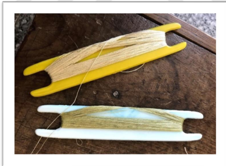
Fotoğraf 2. 7. Mekiklere sarılmış atkılık iplikler.
