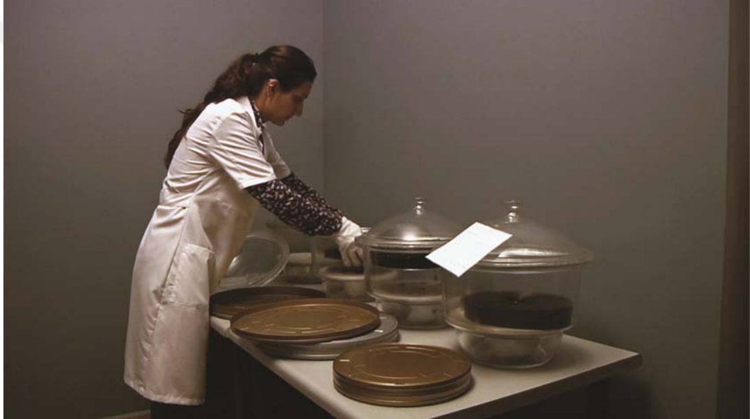
Resim 4.35: Filmlere Kaybettikleri Nem ve Bükülebilirlik Özelliğini Yeniden Kazandırmak İçin Filmler Cam Kaplar İçerisinde Bekletiliyor
