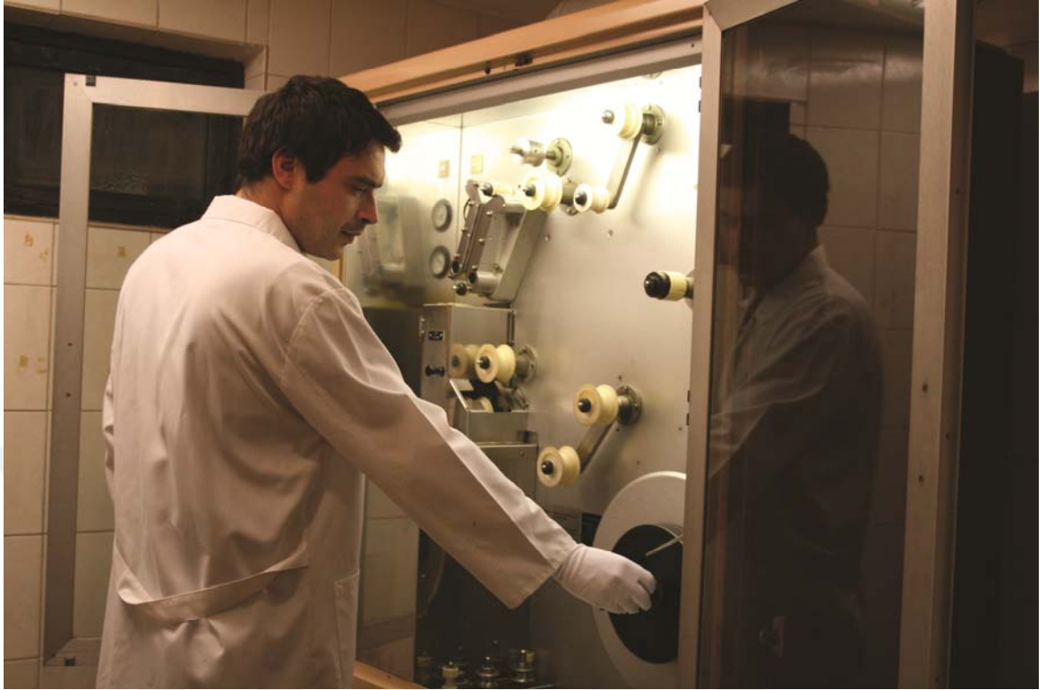
Resim 4.30: Filmlerin Yağdan, Kirden ve Tozdan Arındırıldığı Ultrasonik Film Temizleme Makinesi
