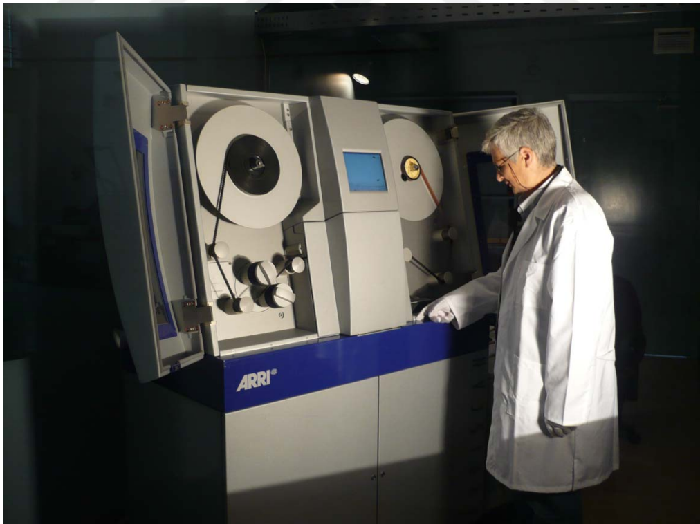
Resim 4.14: Prof. Sami Şekeroğlu Sinema-TV Merkezi Laboratuvarlarında Film Kare Kare Taranarak Dijital Ortama Aktarılıyor
