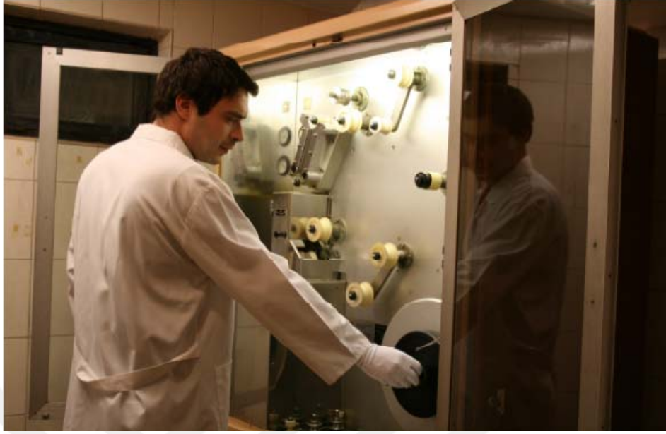
Resim 4.17: Prof. Sami Şekeroğlu Sinema-TV Merkezi'nde Filmler Özel Bir Solventle Temizleniyor, Yağ ve Tozdan Arındırılıyor
