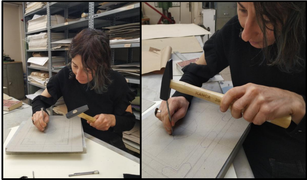
Resim-5.1-7: Oyma çivileri yardımıyla kalıbın oyulması
